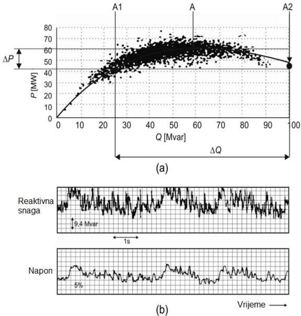
**Slika 2.3.** (a) kružni dijagram lučne peći; (b) primjer promjene jalove snage i kolebanja napona na električnim sabirnicama lučne peći [4].
