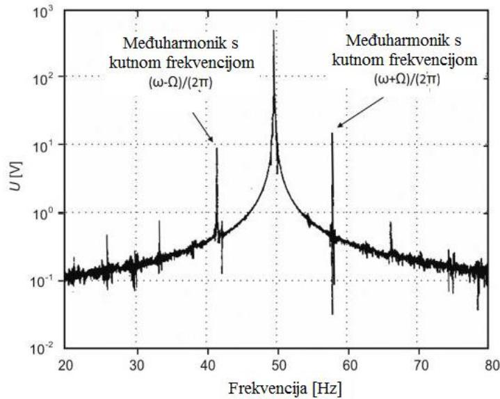
**Slika 2.9.** Grafičko tumačenje frekvencijskog spektra amplitude moduliranog napona [4]
