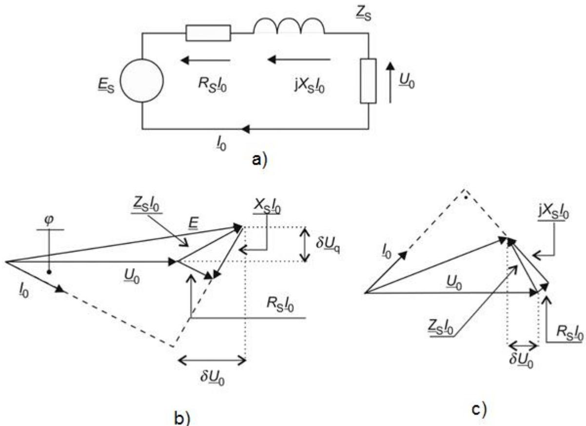
**Slika 2.2.** Jednofazna nadomjesna mreža opskrbne mreže (a) i fazorski dijagrami za induktivno opterećenje  $E_s \geq U_o$  (b) te za kapacitivno opterećenje  $E_s \leq U_o$  (c) [4]
