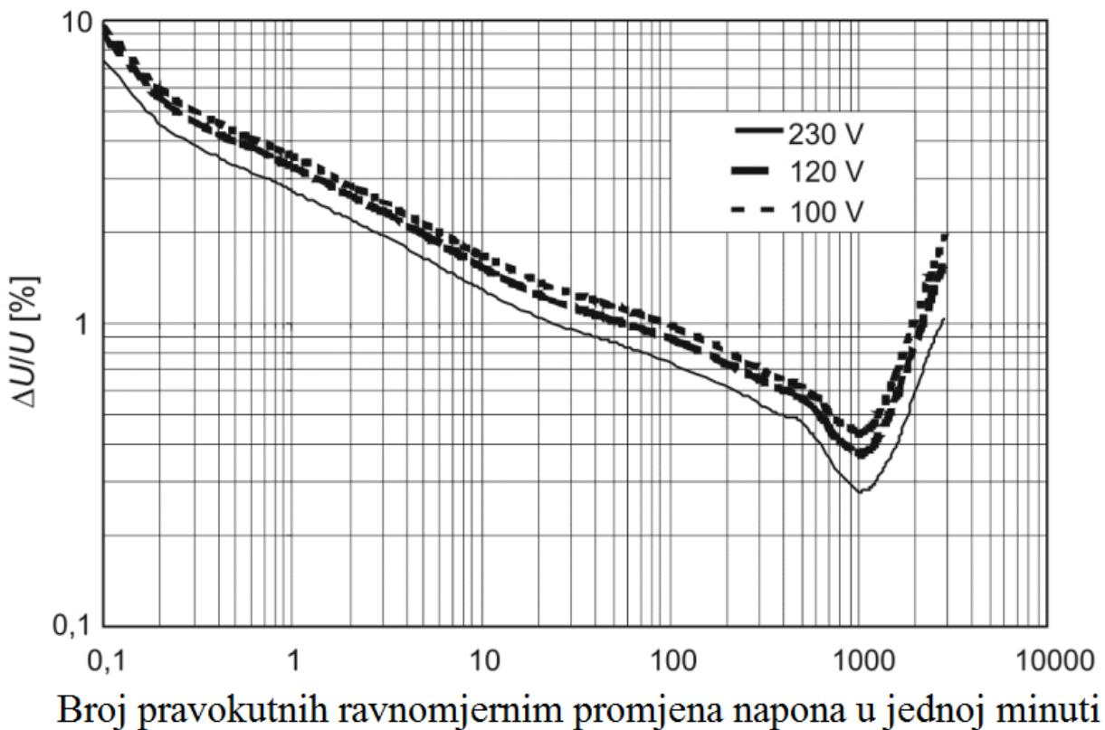
Slika 4.3. Karakteristika pravokutnih ravnomjernih promjena napona u jednoj minuti
