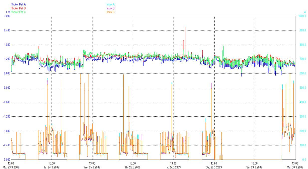
**Slika 5.3.** 10-minutne efektivne usrednjene vrijednosti struje i kratkotrajanog treperenja ( $P_{st}$ ) kotlovnice
