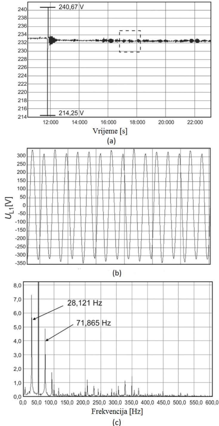
**Slika 2.11.** Valni oblik izlaznog napona UPSa: (a) RMS vrijednost, (b) trenutačna vrijednost, i (c) napon spektra [4]
