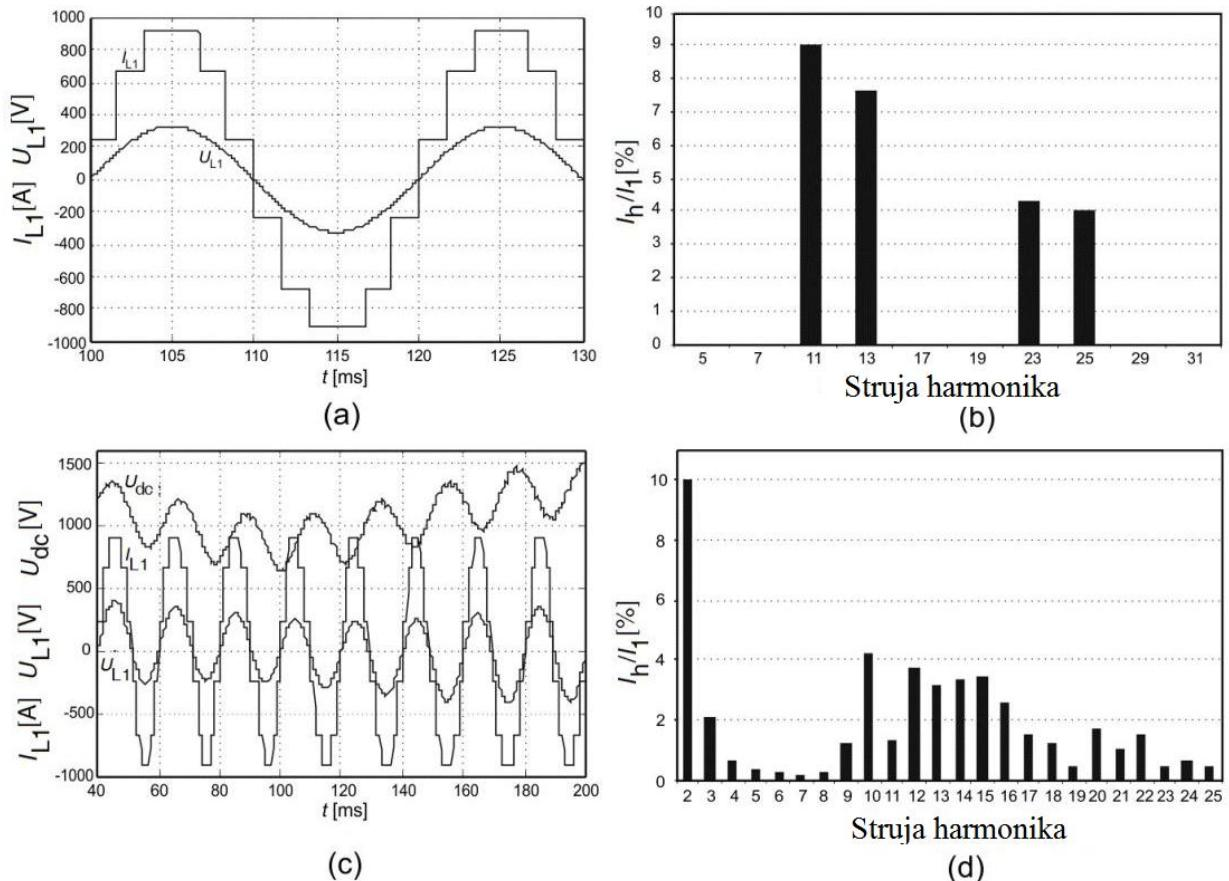
**Slika 2.22.** Valni oblici napona i struje mreže 12-pulsnog ispravljača sa kutovima upravljanja  $\alpha_D = \alpha_Y = 0$  i konstantnom istosmjernom strujom  $I_d = \text{const}$ :
