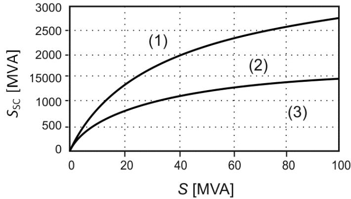
**Slika 2.4.** Karakteristike koje omogućuju procjenu emisija naponskog treperenja uzrokovanih radom peći [4]
