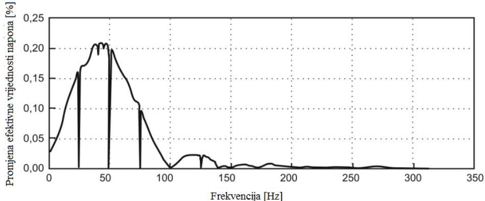
**Slika 2.10.** Promjena efektivne vrijednosti napona uzrokovana međuharmonikom s promjenjivom frekvencijom i konstantnom amplitudom  $m = 0,2\%$  temeljne komponente  $U_1$  [4]
