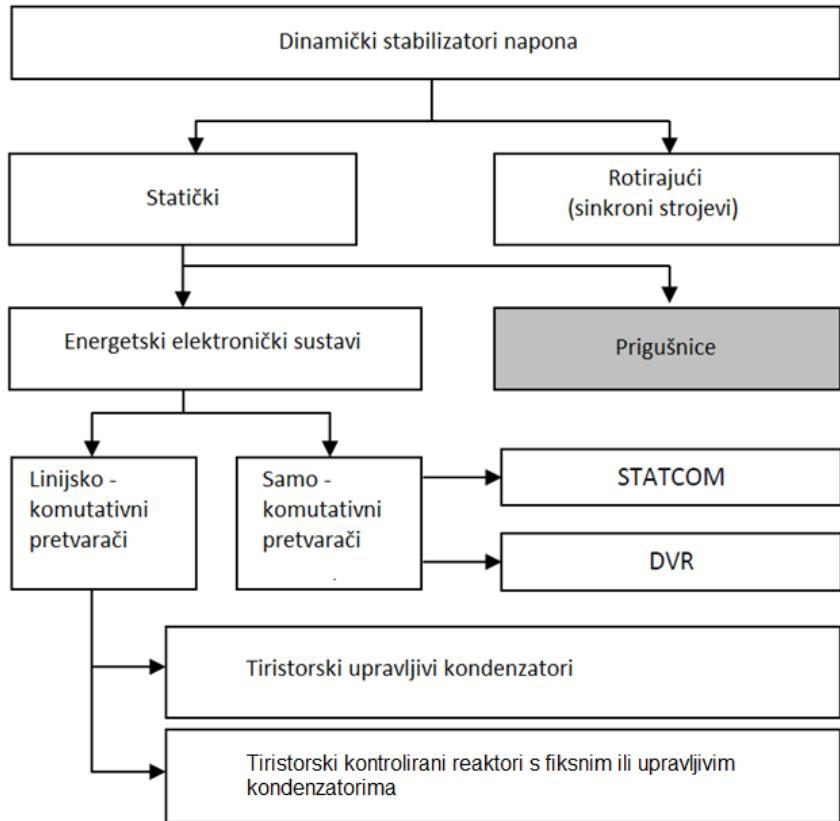
**Slika 4.5.** Podjela dinamičkih stabilizatora napona [4]
