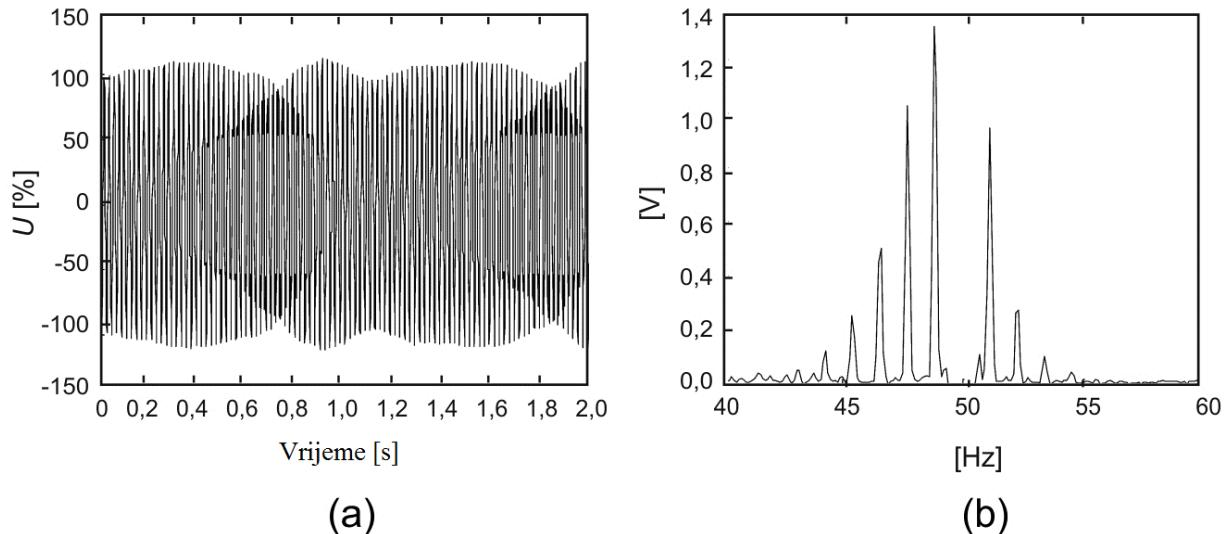
**Slika 2.6.** a) kolebanje napona na priključcima elektromotora velike snage s promjenjivim opterećenjem
