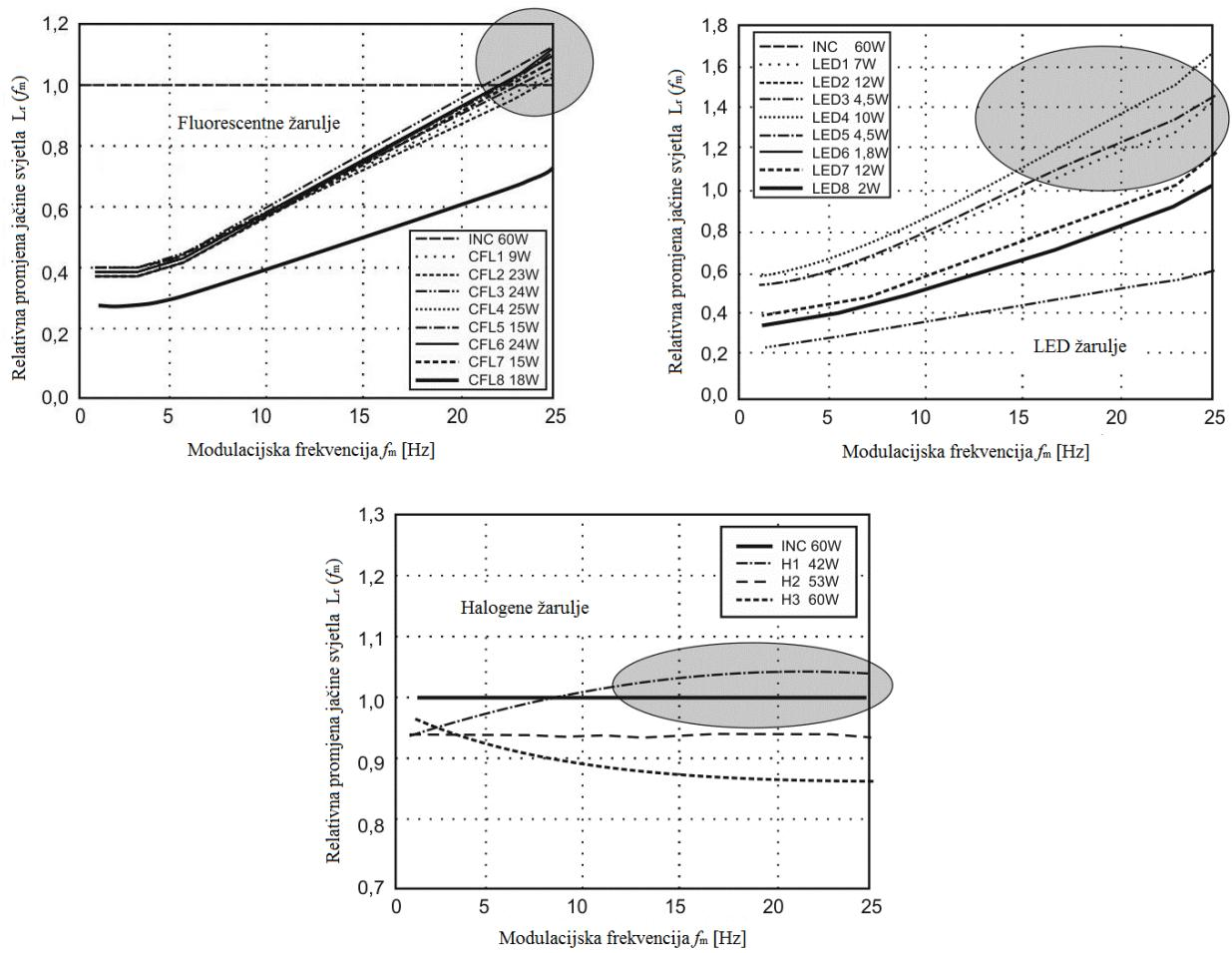
**Slika 2.21.** Primjeri karakteristika treperenja energetski učinkovitih izvora svjetlosti (INC - klasične žarulje, CFL1-8 - fluorescentne žarulje , LED1-8 - LED svjetiljke, H1-3 - halogene žarulje) [4]
