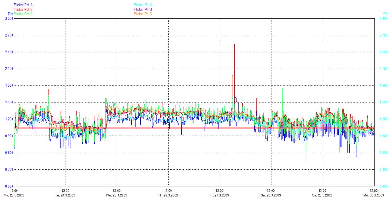
Slika 5.2. Kratkotrajno ( $P_{st}$ ) i dugotrajno ( $P_{lt}$ ) treperenje u kotlovnici
