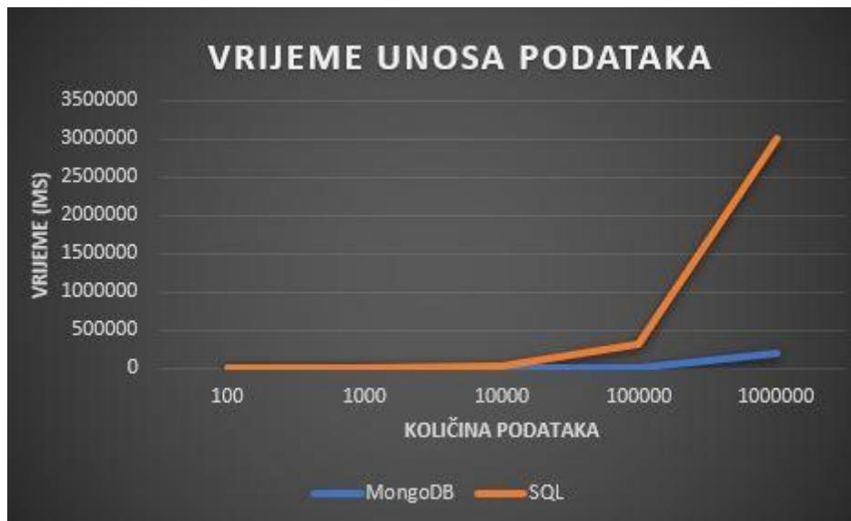
**Slika 6.5.** Rezultat testiranja brzine unosa podataka
