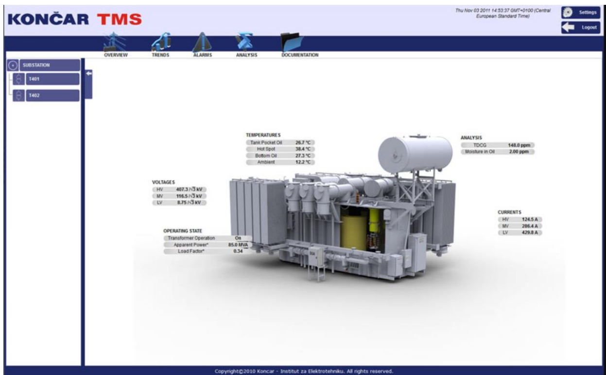
Slika 2.6. Končar TMS, sustav nadzora rada transformatora [19]
