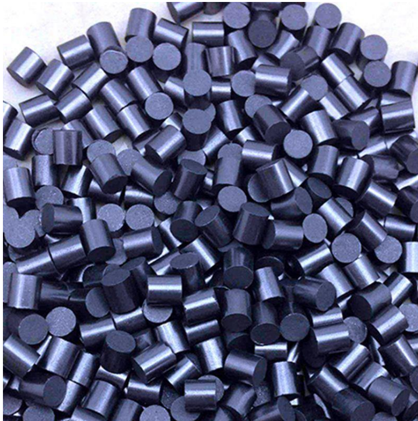
Slika 4.8. Granule sintetičkog grafita visoke čistoće [30]
