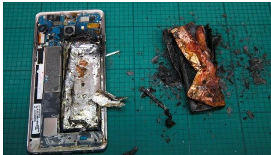
Slika 5.2. Prikaz mobitela Samsung Galaxy Note 7 koji je eksplodirao prilikom pregrijavanja zbog loše konstrukcije i upotrebe pogrešnih materijala u izradi baterija [35]
