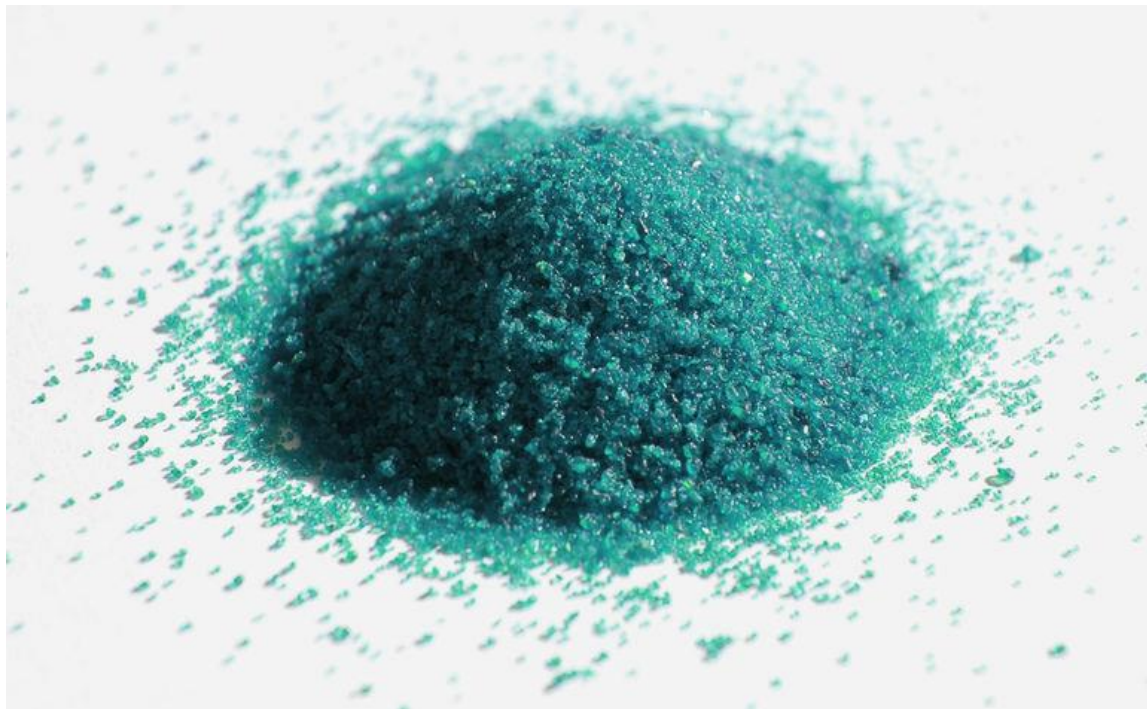
Slika 4.12. Nikal sulfat je važan u kemiji katodnih aktivnih materijala za upotrebu u baterijama električnih vozila [33]
