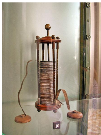
Slika 2.2. Električna baterija Alessandra Volte [4]
