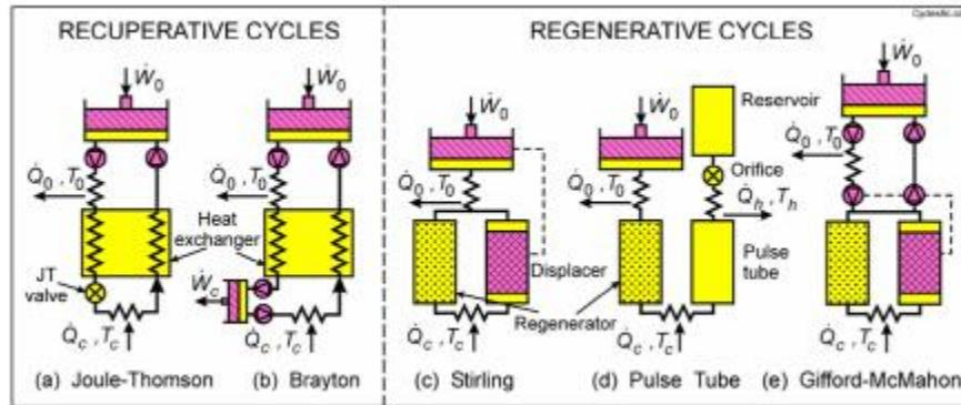
Slika 5.1. Shematski prikaz različitih tipova *cryocoolera* (Radebaugh, 2009, str. 2).
