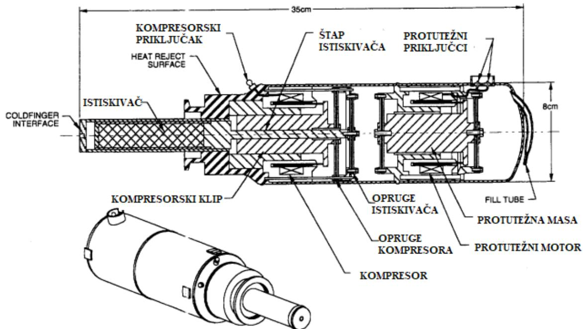
Slika 6.1. Shematski prikaz *cryocoolera* M77B (Boyle, 2002, str. 2).
