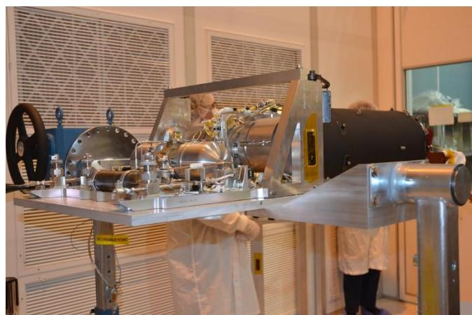
Slika 7.4. MIRI *cryocooler* iz JWST-a (MIRI).
