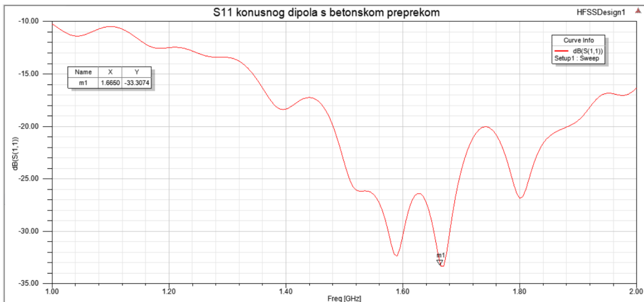
Slika 5.57. Koeficijent refleksije S_{11} konusnog dipola s betonskom preprekom u frekvencijskom opsegu 1-2 GHz
