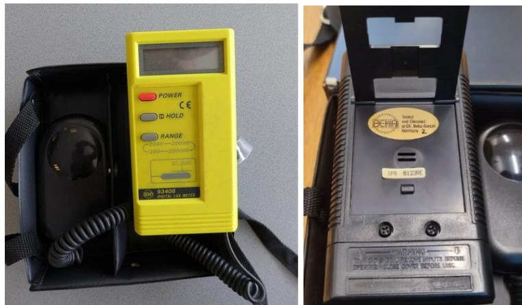
Slika 5.14. UNITEST Digital Luxmeter 93408 [54]
