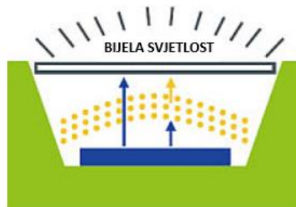
Slika 4.3. Plavi LED + žuti fosfor [32]
