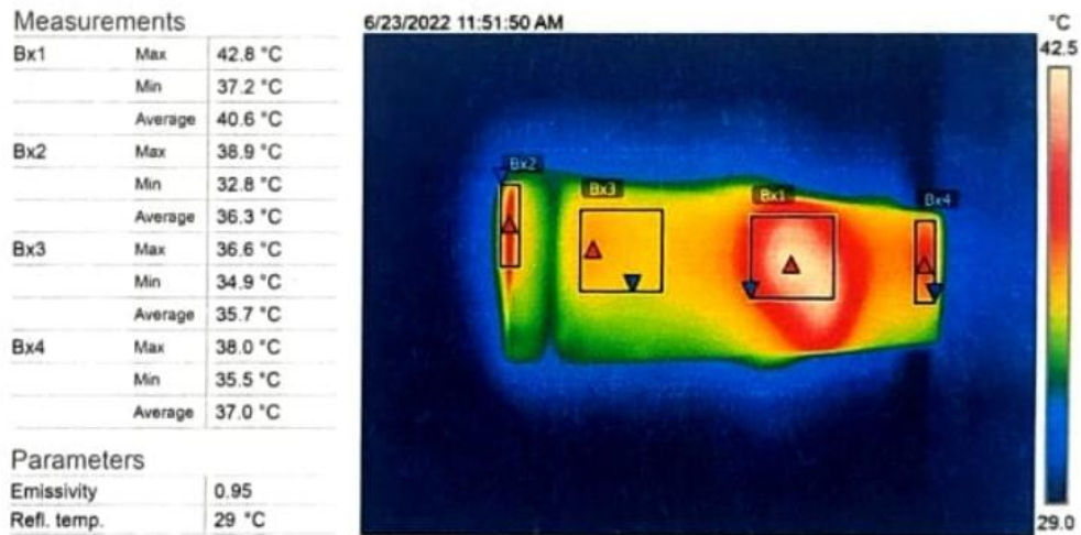
Slika 5.1. Termalni obrazac neposredno nakon otkaza prigušnice [48]
