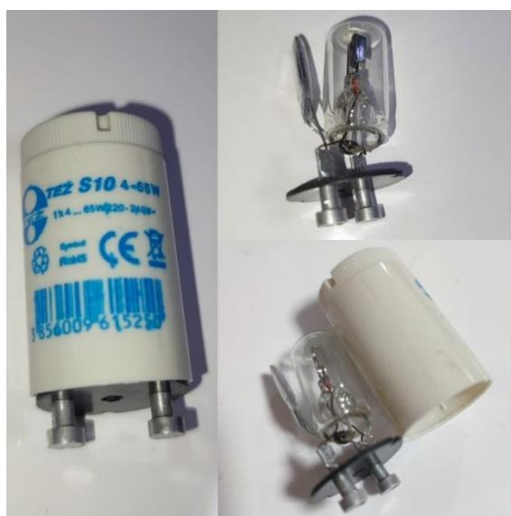
**Slika 3.5.** Starter sa i bez kućišta
