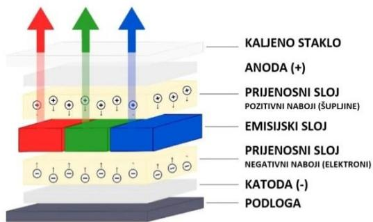
**Slika 4.6.** Struktura OLED-a [40]
