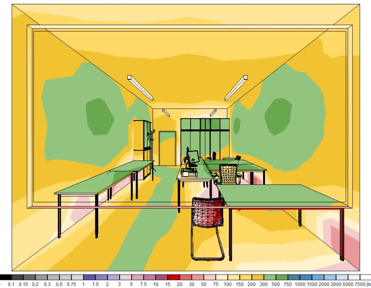
**Slika 5.11.** Rezultati osvjetljenja ploha primjenom Solo LED 55 W
