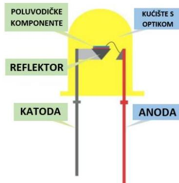
Slika 4.1. Presjek i osnovni dijelovi svjetleće diode [28]
