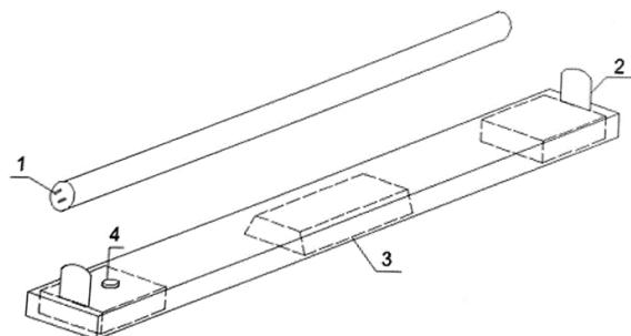
**Slika 3.4.** Fluorescentna cijev s predspojnim napravama ( 1 – kontaktne nožice, 2 – nosač cijevi, 3 – prigušnica, 4 – starter ) [12]
