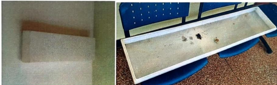
Slika 5.4. Difuzor rasvjetnog tijela i komadi plastičnog kućišta prigušnice uočeni termografskom analizom
