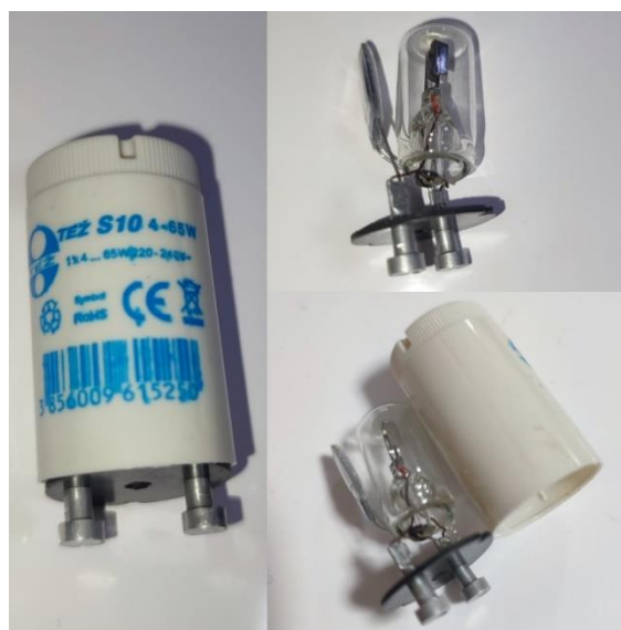
Slika 3.5. Starter sa i bez kućišta
