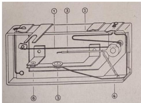
**Slika 3.6.** Termički starter sa osnovnim dijelovima [19]
