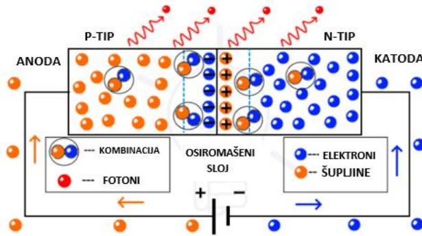
**Slika 4.2.** Princip rada svjetleće diode [30]
