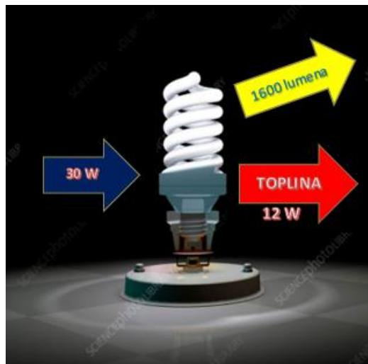
**Slika 3.13.** Energetka učinkovitost CFL žarulje snage 30 W [26]
