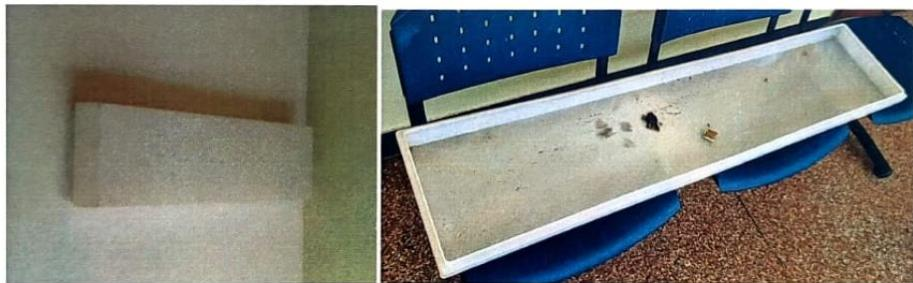
**Slika 5.4.** Difuzor rasvjetnog tijela i komadi plastičnog kućišta prigušnice uočeni termografskom analizom
