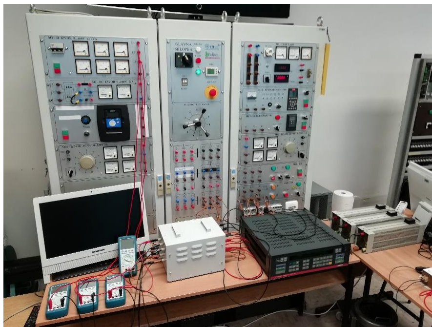
Sl. 3.21. Provedba mjerenja pri simetričnom opterećenju transformatora
