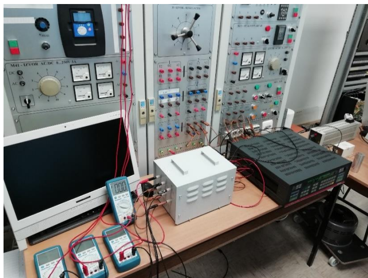
Sl. 3.65. Provedba mjerenja pri RLC opterećenju transformatora
