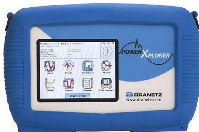
Slika 4.1. Analizator kvalitete električne energije Dranetz Power Xplorer PX5
