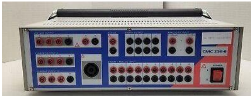
Slika 4.2. Uređaj za testiranje i kalibraciju Omicron CMC 256-6
