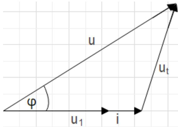
**Slika 2.20.** Fazorski dijagram struja i napona prilikom neizravnog mjerjenja snage u AC sustavu pomoću 3 voltmetra
