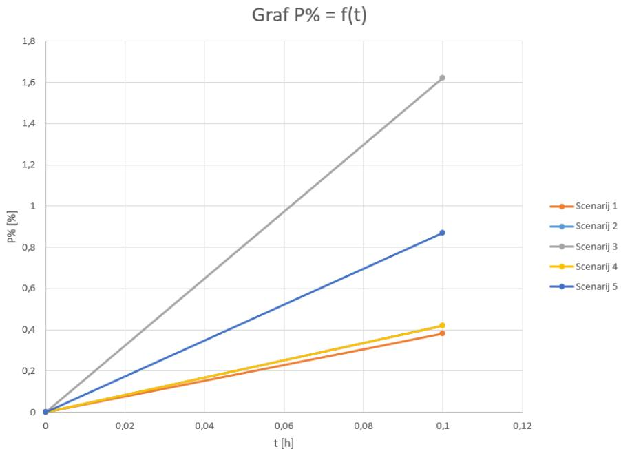
**Slika 4.10.** Grafički prikaz odnosa postotnih razlika mjerenja električne snage s pomoću brojila električne energije i ukupne električne snage na svim harmonicima analizatorom kvalitete električne energije po scenarijima
