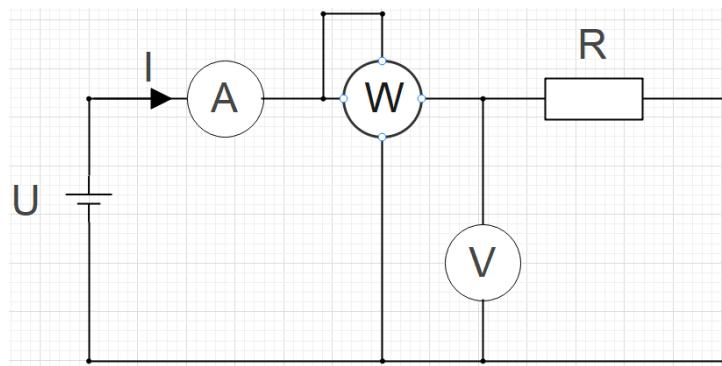
**Slika 2.11.** Metoda izravnog mjerjenja snage u DC sustavu – paralelno izvoru
