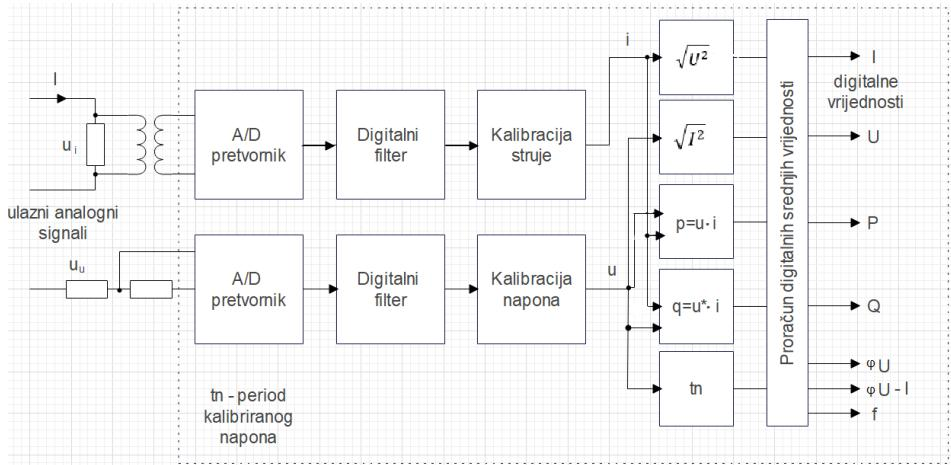
Slika 3.3. Blokovski prikaz arhitekture procesora signala
