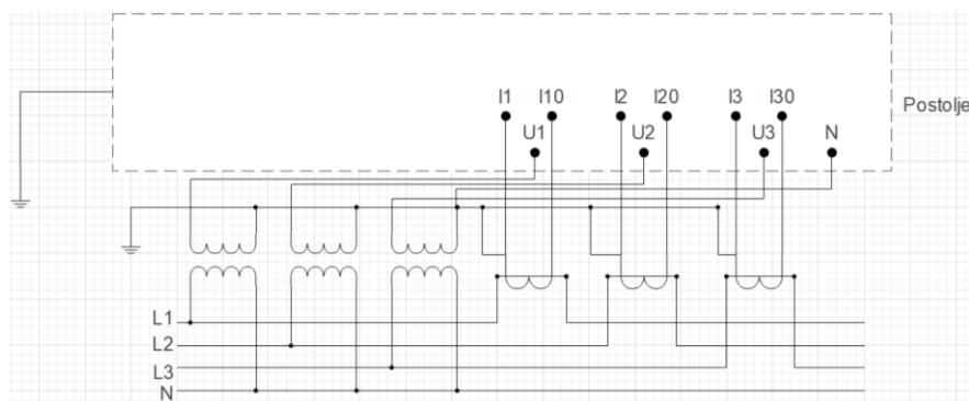
Slika 3.2. Shema priključenja brojila na izvor napajanja
