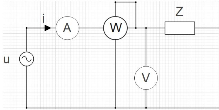
**Slika 2.16.** Metoda izravnog mjerjenja snage u AC sustavu – paralelno trošilu
