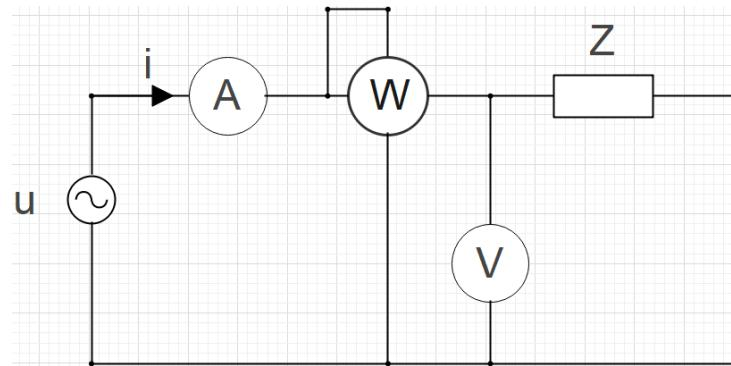
**Slika 2.15.** Metoda izravnog mjerena snage u AC sustavu – paralelno izvoru
