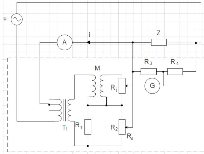
**Slika 2.21.** Metoda neizravnog mjerjenja snage u AC sustavu pomoću izmjeničnog kompenzatora
