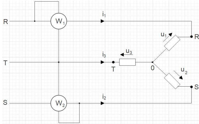
**Slika 2.26.** Metoda mjerena snage u trofaznom sustavu bez nul vodiča pomoću Aronovog spoja dva vatmetra
