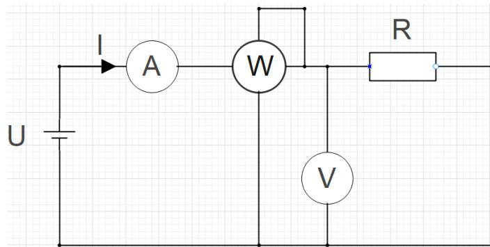
**Slika 2.12.** Metoda izravnog mjerjenja snage u DC sustavu – paralelno trošilu
