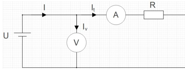
**Slika 2.13.** Metoda neizravnog mjerena snage u DC sustavu – strujni spoj
