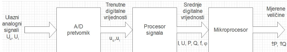
Slika 3.4. Blokovski prikaz mjernog sustava brojila električne energije
