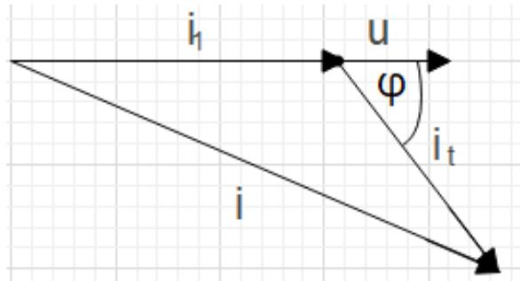
**Slika 2.18.** Fazorski dijagram struja i napona prilikom neizravnog mjerjenja snage u AC sustavu pomoću 3 ampermetra
