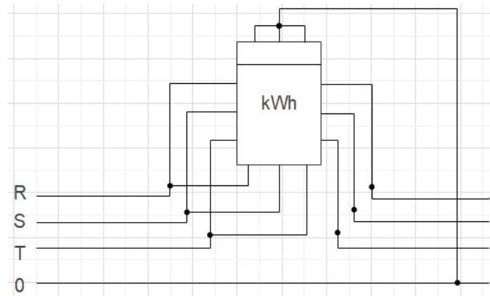
**Slika 2.8.** Metoda mjerena djelatne energije u trofaznom sustavu sa nul-vodičem pomoću trofaznog induksijskog brojila djelatne energije (M-spoj)
