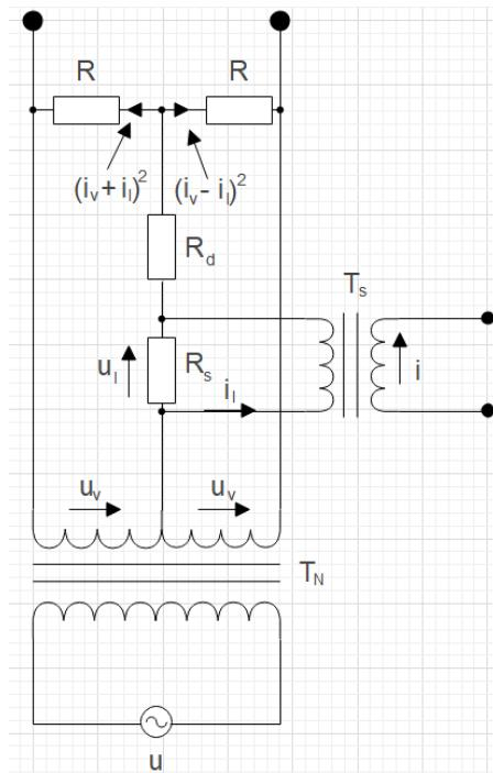
**Slika 2.22.** Metoda neizravnog mjerjenja snage u AC sustavu pomoću paraboličnog multiplikatora
