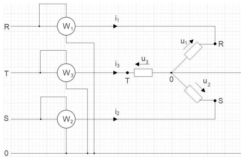
**Slika 2.25.** Metoda mjerena snage u trofaznom sustavu pomoću tri vatmetra
