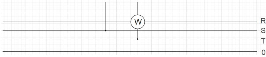
**Slika 2.28.** Metoda mjerena jalove snage u trofaznom sustavu pomoću jednog vatmetra
