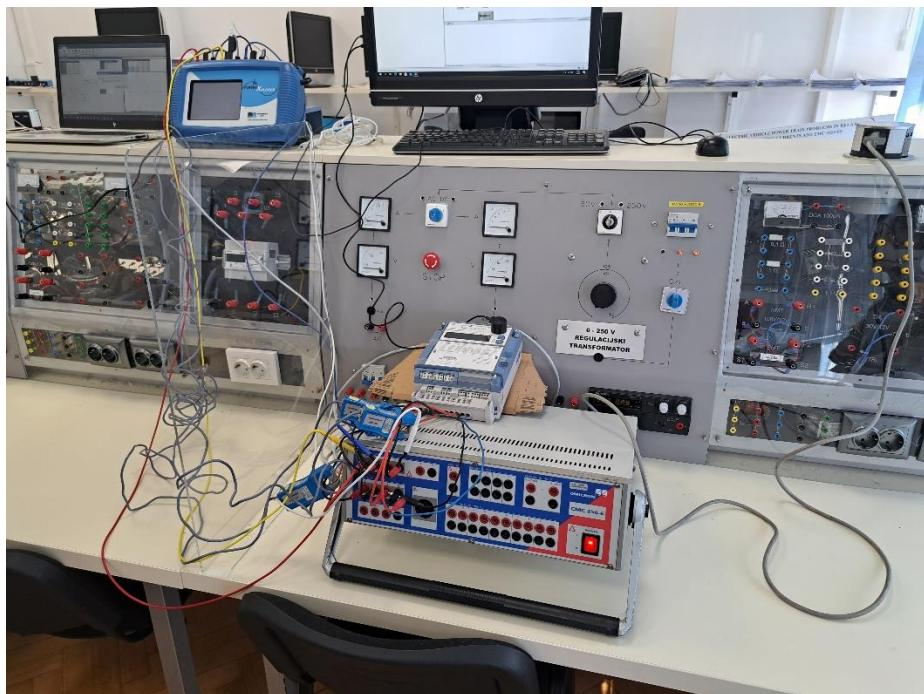
**Slika 4.4.** Mjerni postav prilikom mjerena brojilom električne energije
