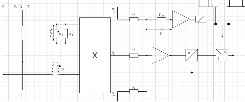
**Slika 2.10.** Blok shema električnog brojila
