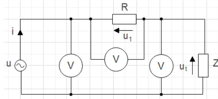
**Slika 2.19.** Metoda neizravnog mjerjenja snage u AC sustavu pomoću 3 voltmetra
