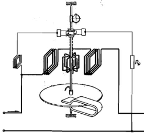
**Slika 2.3.** Elektrodinamsko brojilo (V., Bego, „Mjerenja u elektrotehnici“, Tehnička knjiga Zagreb, Zagreb, 1979.) AC brojila električne energije se mogu podijeliti na induksijska trofazna brojila djelatne energije, induksijska jednofazna brojila djelatne energije, induksijska brojila jalove energije, brojila prividne energije (kombinacija brojila djelatne i brojila jalove energije) i statička (elektronička) trofazna brojila radne i jalove energije.
