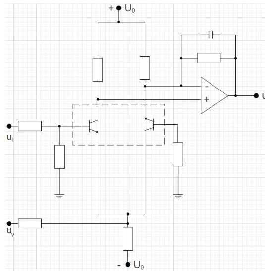
**Slika 2.23.** Metoda neizravnog mjerjenja snage u AC sustavu pomoću tranzistorskog multiplikatora
