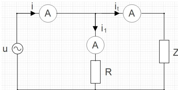
**Slika 2.17.** Metoda neizravnog mjerjenja snage u AC sustavu pomoću 3 ampermetra
