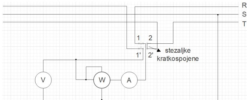
**Slika 2.27.** Metoda mjerena snage u trofaznom sustavu pomoću jednog vatmetra spojenog u Aronov spoj
