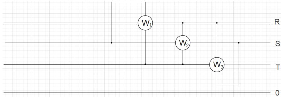
**Slika 2.29.** Metoda mjerena jalove snage u trofaznom sustavu pomoću tri vatmetra
