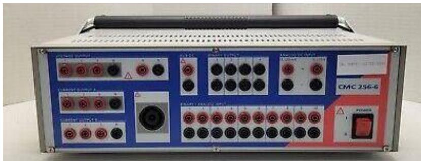
Slika 4.2. Uredaj za testiranje i kalibraciju Omicron CMC 256-6
