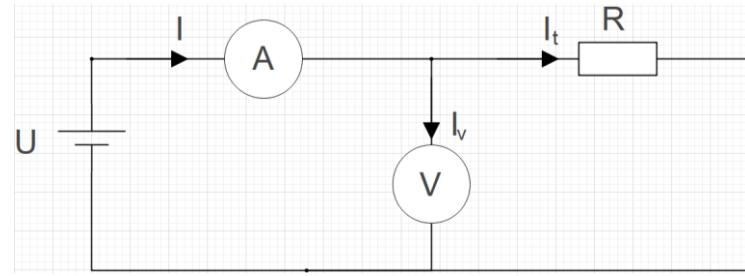
**Slika 2.14.** Metoda neizravnog mjerena snage u DC sustavu – naponski spoj
