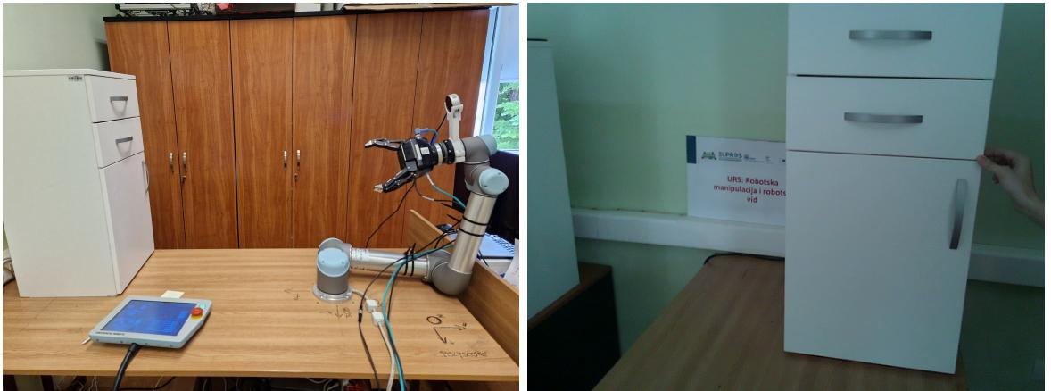
(a) Položaj robotskog manipulatora prikladan (b) Snimljena RGB slika iz položaja prikaza za snimanje scene.
