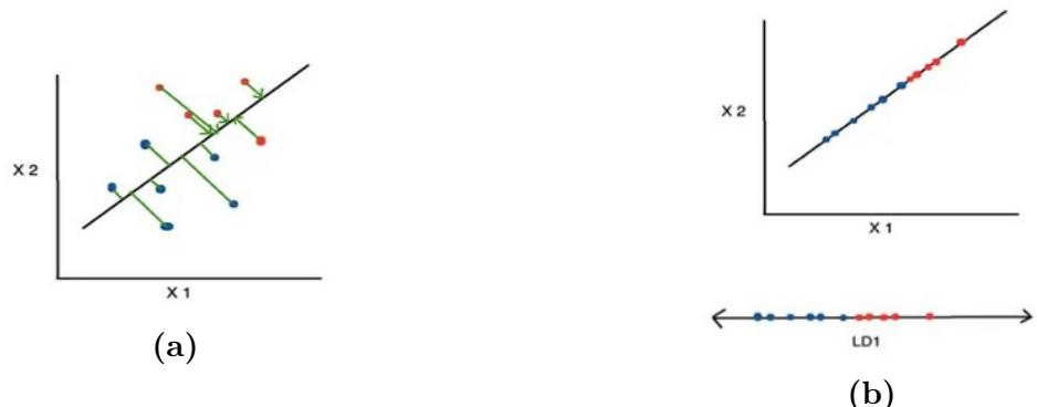
**Slika 3.11:** Novo generirani pravac pomoću algoritma LDA (a) i prikaz novog rasporeda u 1D ravnini (b) [26]
