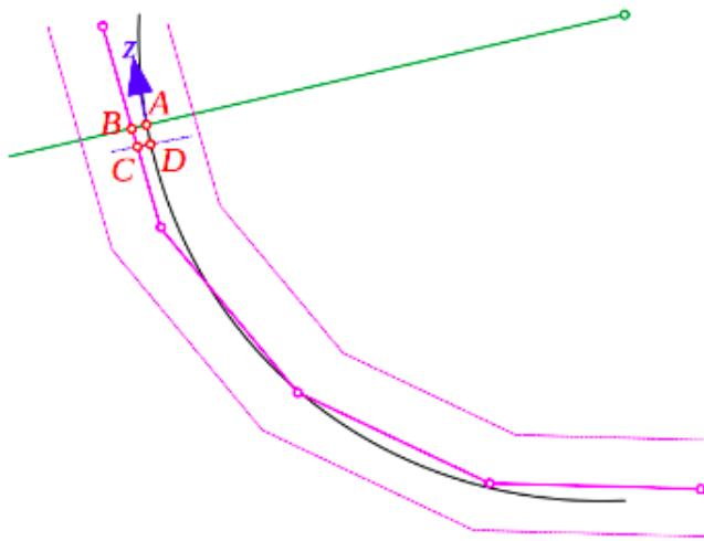
**Slika 3.4:** Ispravak trajektorije otvaranje vrata hibridnim upravljanjem
