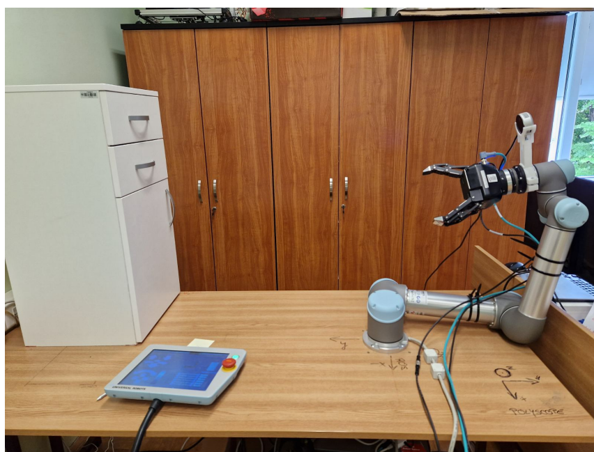
Slika 6.16: Primjer lošeg položaja robotskog manipulatora u trenutku snimanja scene
