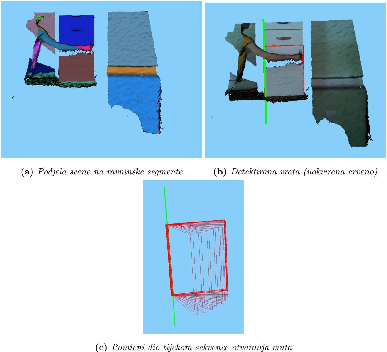
**Slika 3.1:** Postupak detekcije vrata na temelju sekvence slika
