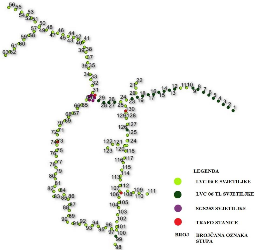
Sl. 3.1. Mapirani elementi sustava javne rasvjete [24]
