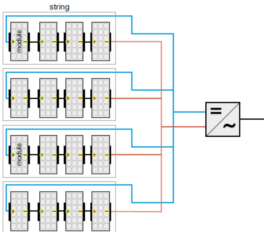
Sl.3.4. Polje fotonaponskih modula sa jednim izmjenjivačem [8]
