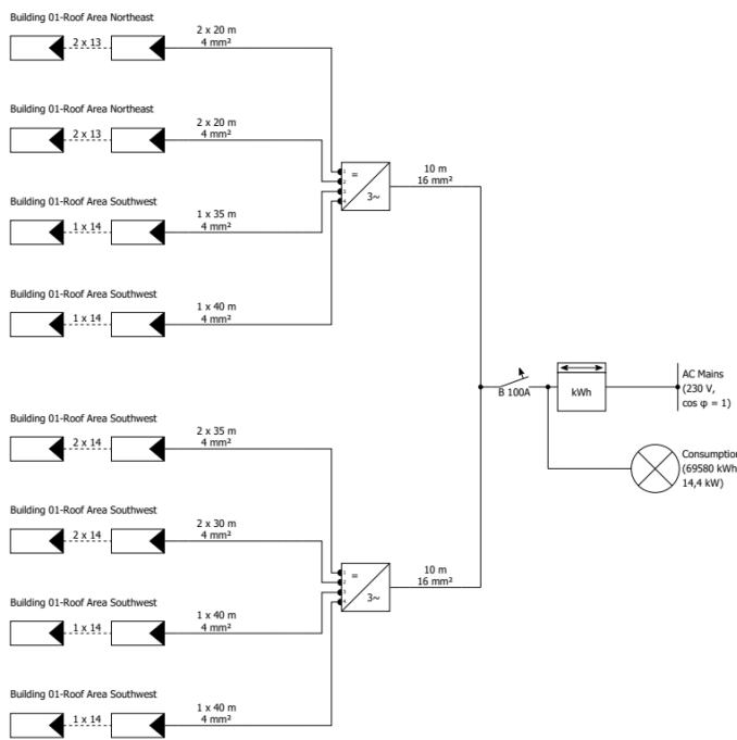
**Slika 5.14.** Jednopolna shema sustava
