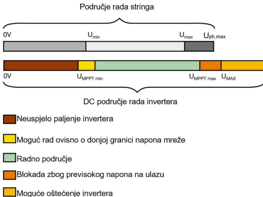
Sl.3.7. Raspon nazivnih napona izmjenjivača i fotonaponskog polja[8]
