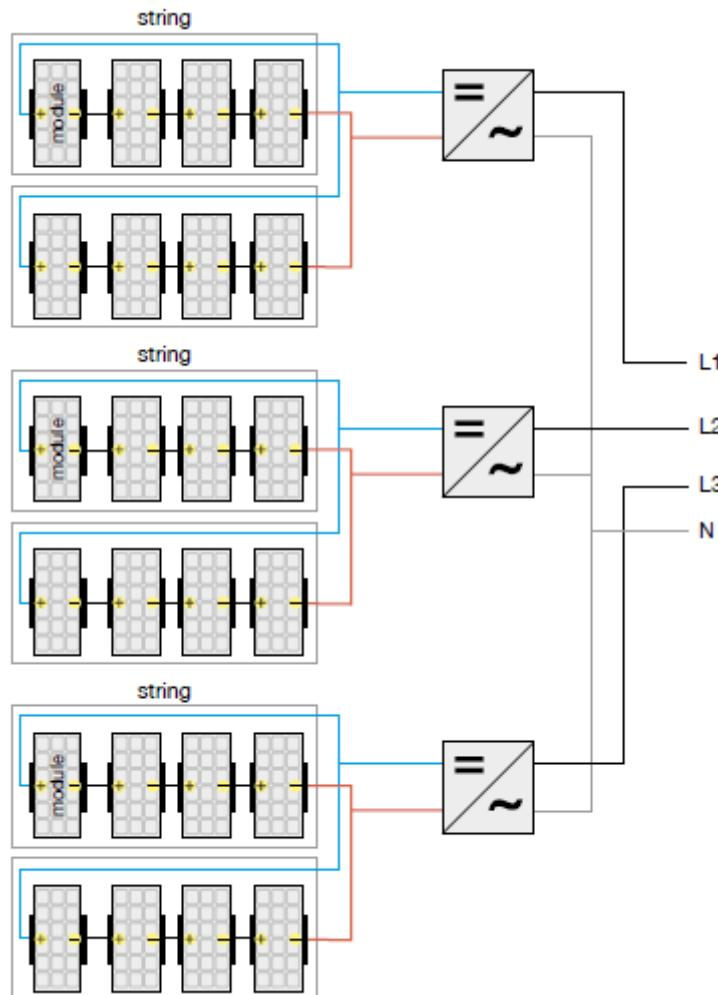
**Sl.3.6.** Polje fotonaponskih modula sa jednim izmjenjivačem za svako podpolje [8]
