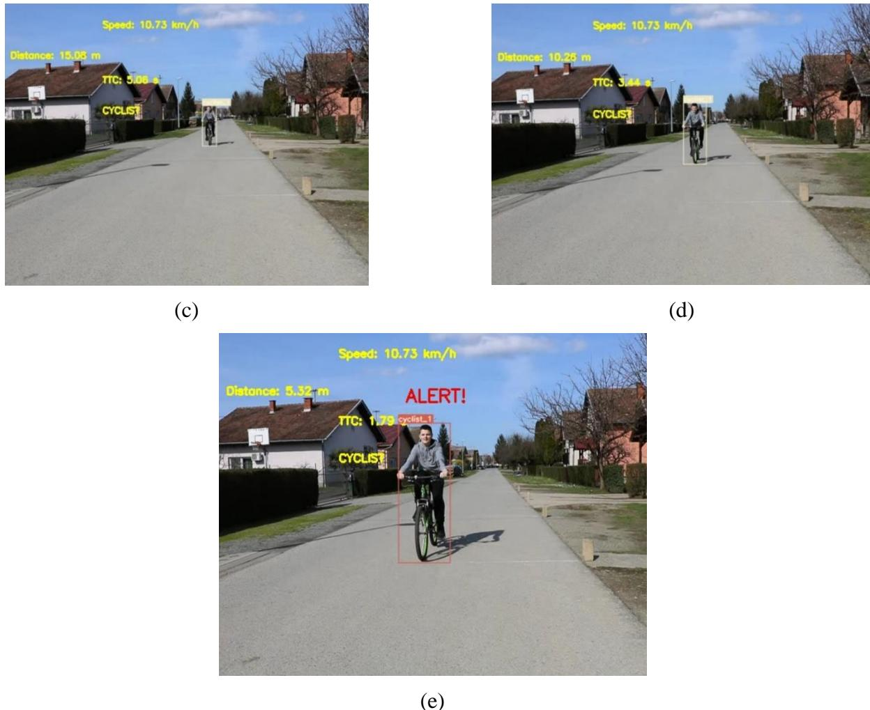
**Slika 4.4.** Rezultati rada rješenja za video sekvencu *cyclist1\_10.mp4*, stvarna brzina 10 km/h, biciklist na (a) 25 m, (b) 20 m, (c) 15 m, (d) 10 m, (e) 5 m udaljenosti od kamere
