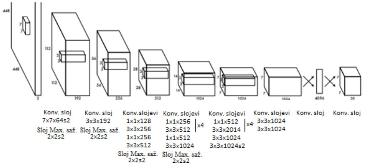
**Slika 2.7.** Arhitektura CNN osnovnog YOLO algoritma [8][15]
