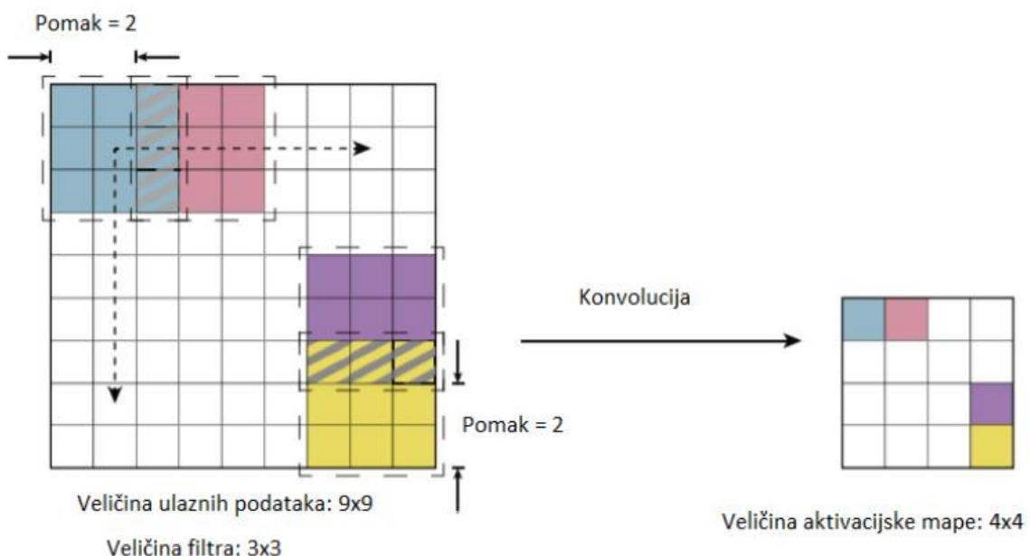
**Slika 2.2.** Primjer operacije konvolucije nad ulaznom matricom  $9 \times 9$  [11]
