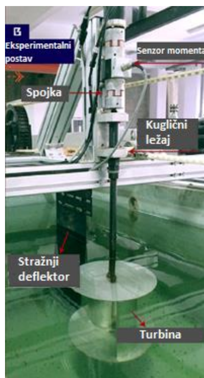
Slika 3.25. Eksperimentalni postav Savoniusove turbine sa ravnim deflektorom [35]
