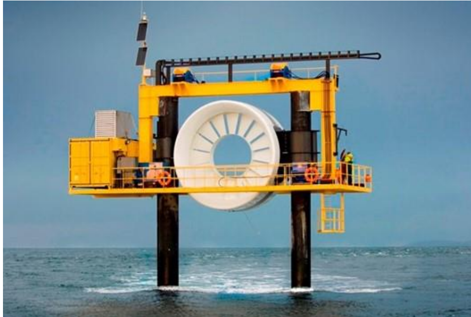
Slika 3.14. OpenHydro turbina, podignuta u svrhu održavanja [30]
