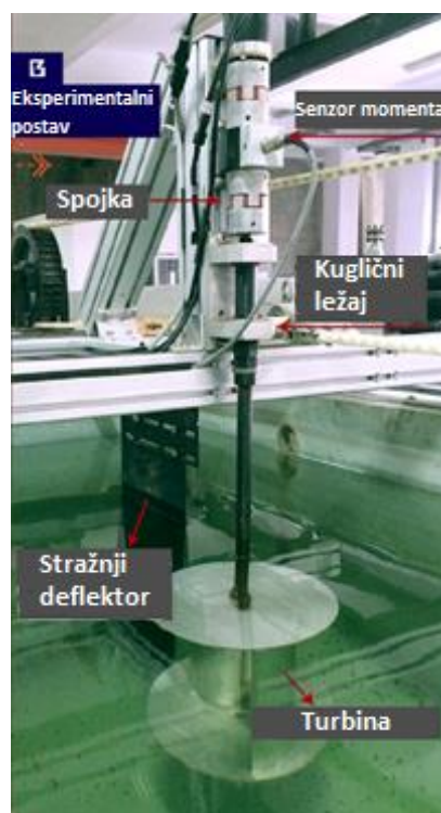
Slika 3.25. Eksperimentalni postav Savoniusove turbine sa ravnim deflektorom [35]
