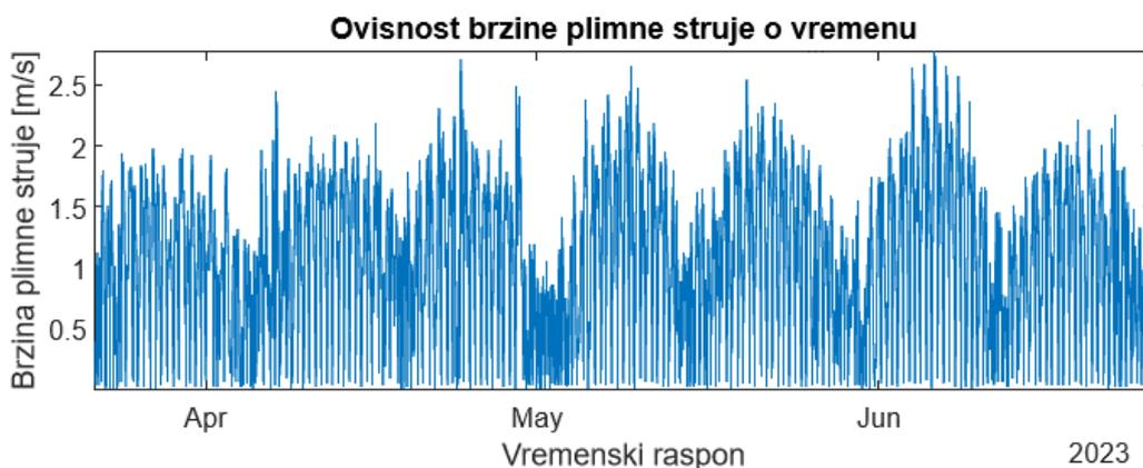
**Slika 4.4.** Graf ovisnosti brzine plimne struje o vremenu
