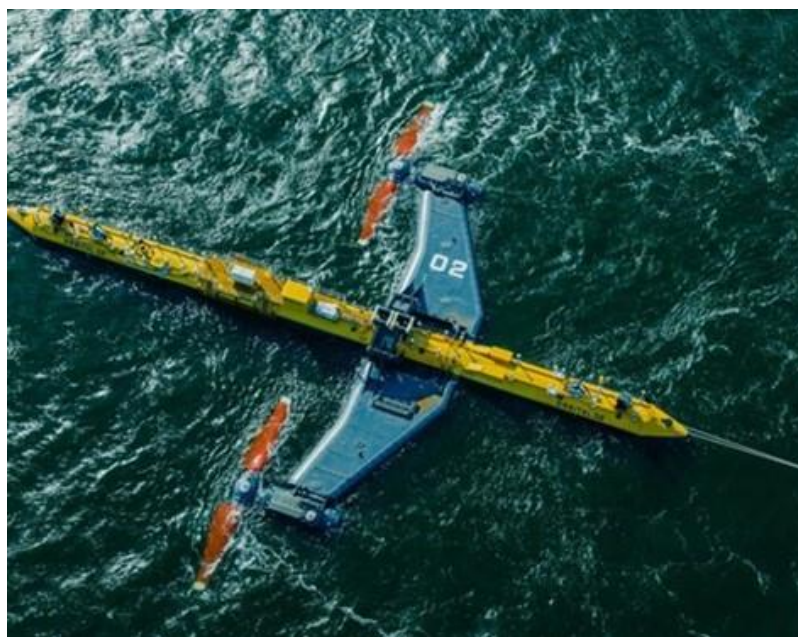
Slika 3.13. O2 turbina, sa podignutim oštricama u svrhu održavanja [29]
