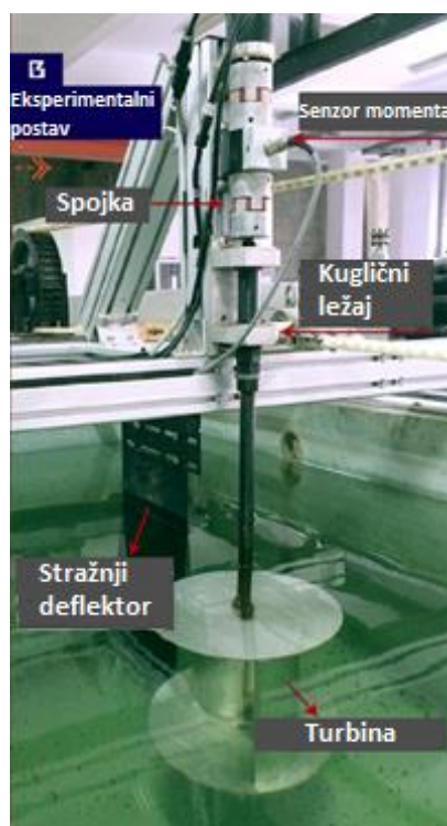
Slika 3.25. Eksperimentalni postav Savoniusove turbine sa ravnim deflektorom [35]
