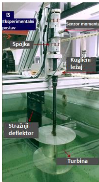
Slika 3.25. Eksperimentalni postav Savoniusove turbine sa ravnim deflektorom [35]
