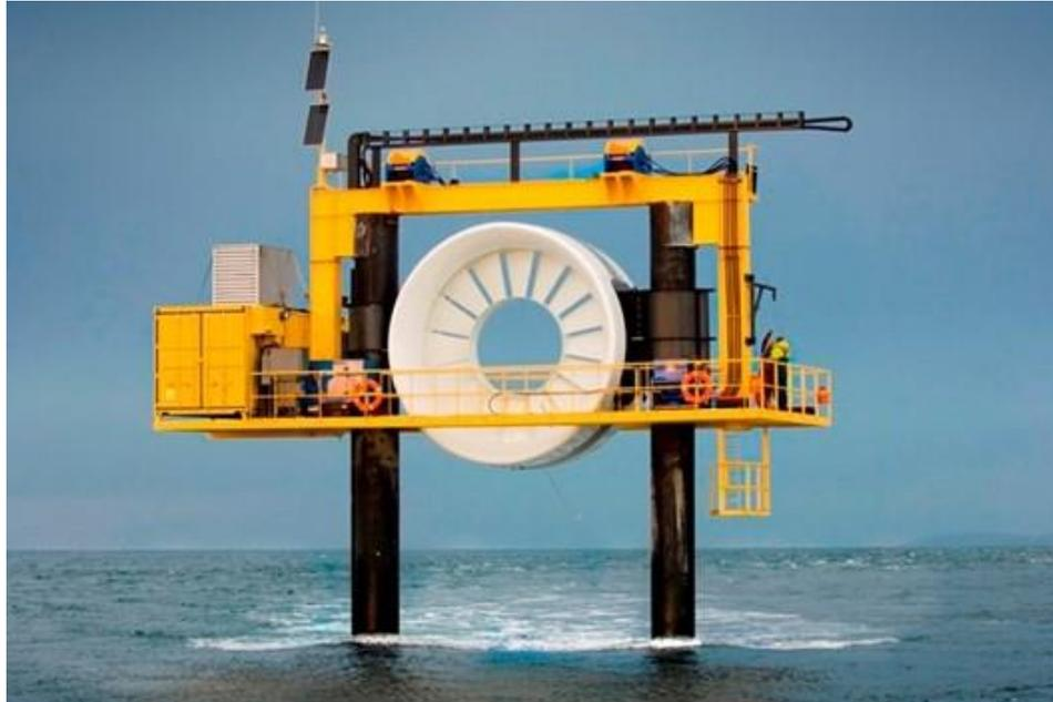
*Slika 3.14. OpenHydro turbina, podignuta u svrhu održavanja [30]*
