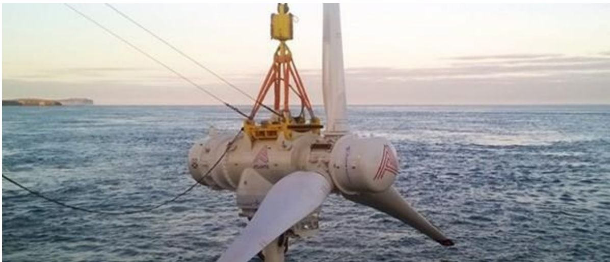
Slika 3.3. Turbina s horizontalnom osi vrtnje, izvedba s tri oštrice [19]
