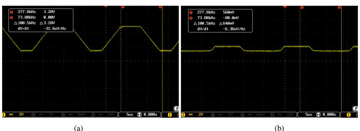
Sl. 3.16. Signal izlaza iz LM358 za PWM modulaciju: (a) visoka razina (b) niska razina
