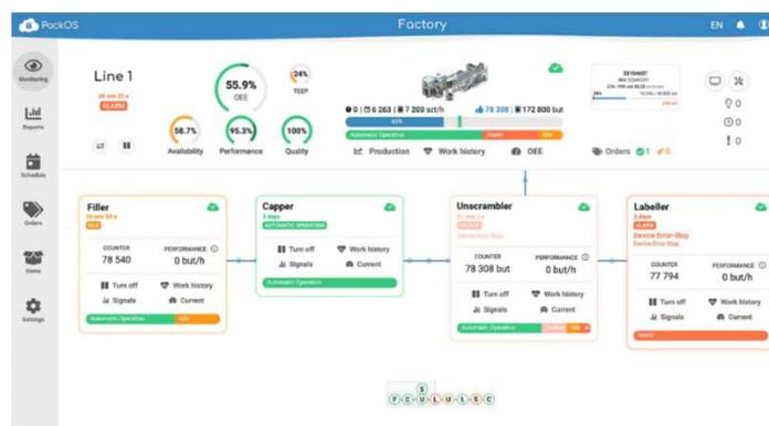
Slika 2.5. Prikaz PackOS sustava za praćenje proizvodnog procesa
