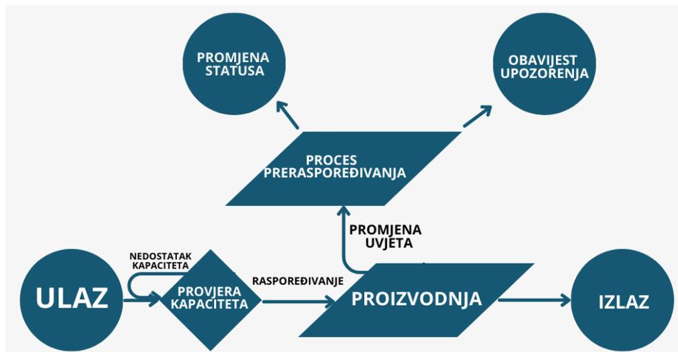
Slika 3.1. Shema dijagrama rada raspoređivanja i preraspoređivanja
