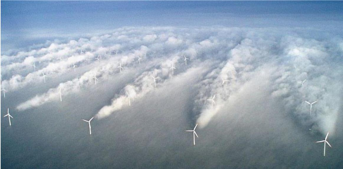
Slika 2.6 Efekt međusobnog zaklanjanja vjetroturbina u vjetroelektrani [6]
