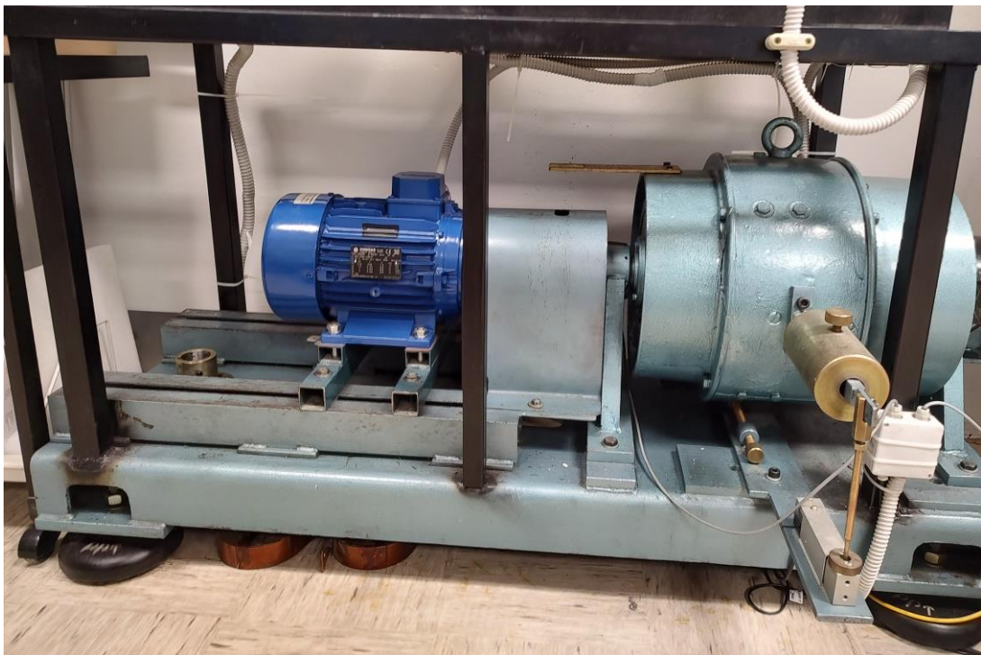
Slika 2.6: Laboratorijski postav AM-DC-M/G
