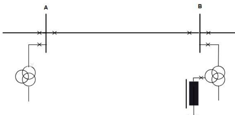
Slika 4.5. Paralelna prigušnica spojena na tercijar transformatora [11]
