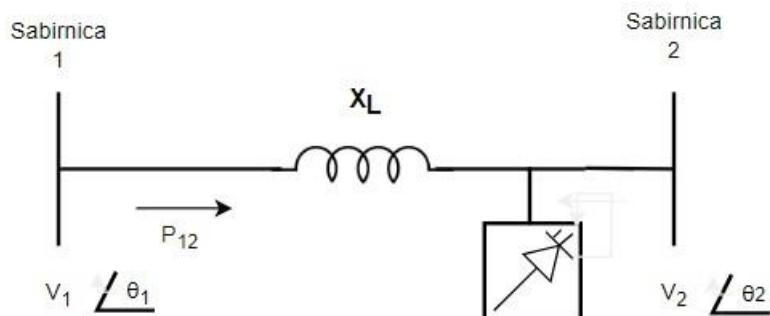
Slika 4.10. Prijenosni vod sa paralelno spojenim FACTS uređajem [14]
