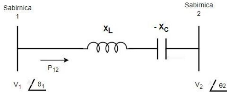
Slika 4.2. Prijenosni vod sa kondenzatorom u seriji [13]
