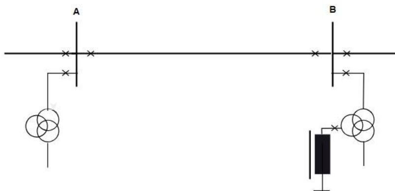
Slika 4.5. Paralelna prigušnica spojena na tercijar transformatora [11]
