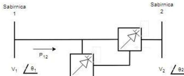
Slika 4.11. Prijenosni vod sa serijsko-paralelnom kompenzacijom [14]
