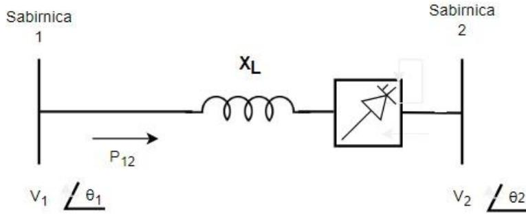
Slika 4.5. Prijenosni vod sa FACTS uređajem spojenim u seriju [14]
