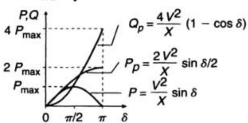
Slika 4.6. Prikaz povećanja prenesene radne snage paralelnom kompenzacijom na sredini voda [14]
