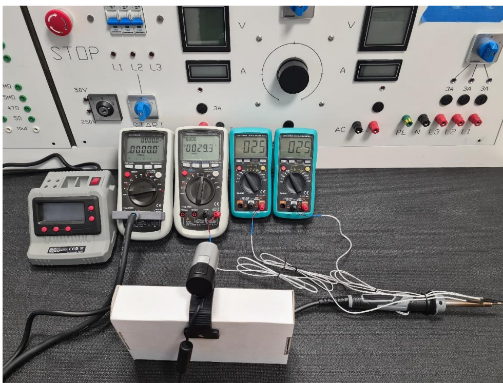
Slika 6.6. prikaz kompletnog spoja potrebnog za obavljanje mjerenja na lemnjici Conrad Electronic LSL-450
