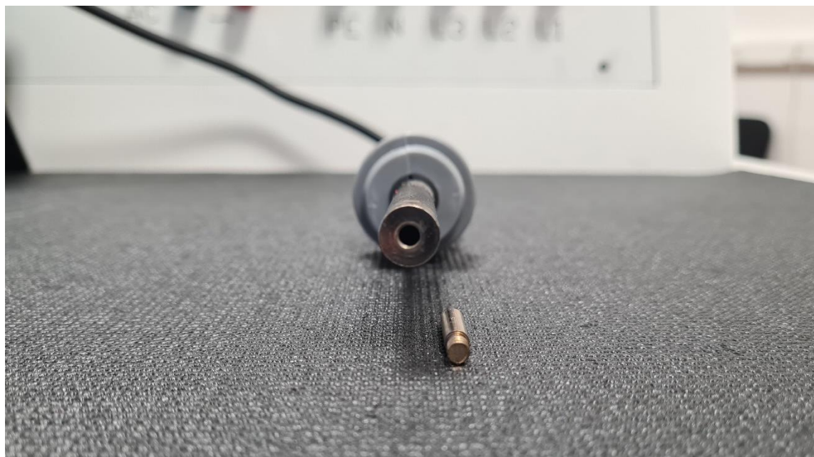
Slika 6.12. Prikaz punog vrha lemne stanice Conrad Electronic LSL-450
