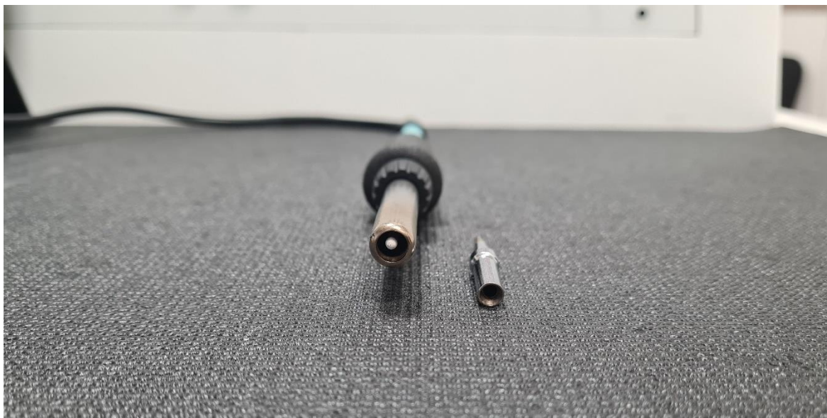
Slika 6.11. Prikaz šupljeg vrha lemne stanice Weller WE-1010
