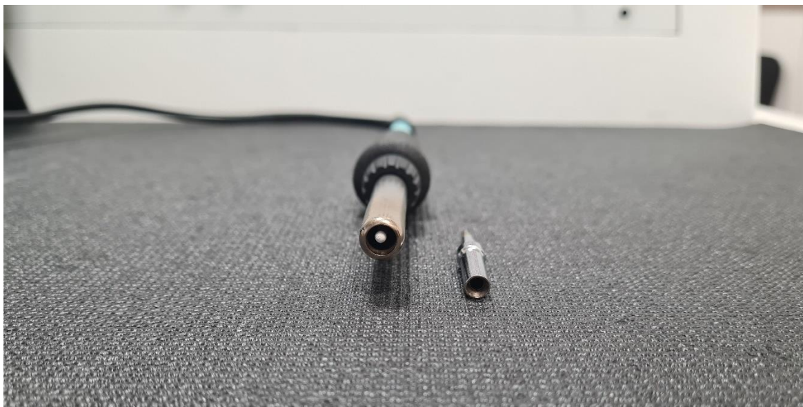
Slika 6.11. Prikaz šupljeg vrha lemne stanice Weller WE-1010
