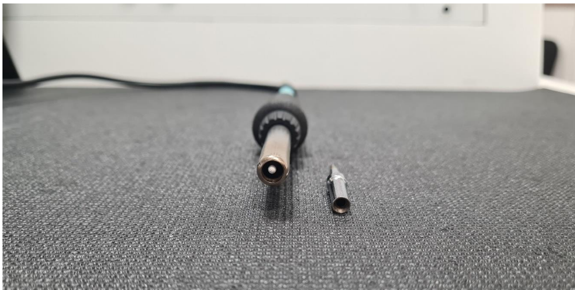
Slika 6.11. Prikaz šupljeg vrha lemne stanice Weller WE-1010
