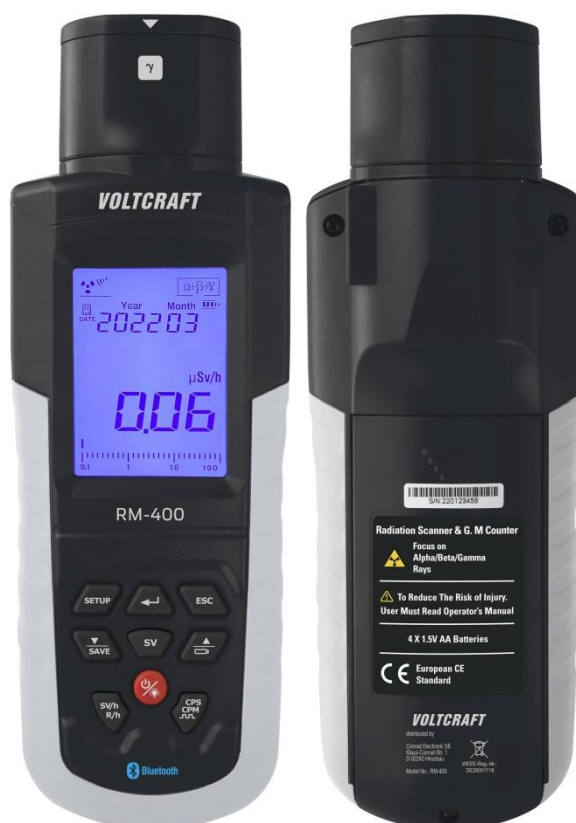
Slika 5.1. Prednja i zadnja strana Geigerovog mjerača zračenja Voltcraft RM-400
