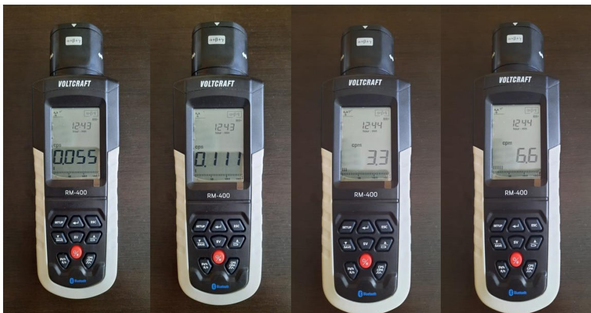
Slika 5.11. Cps (prva i druga slika s lijeve strane) i cpm (prva i druga slika s desne strane) za prirodno pozadinsko zračenje
