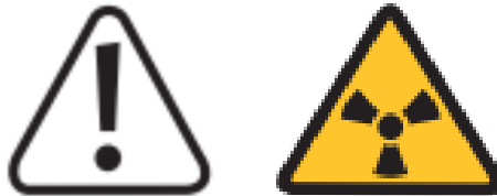
Slika 5.2. Simbol upozorenja na opasnosti ozljeđivanja (lijevo) i simbol upozorenja na radijaciju (desno)
