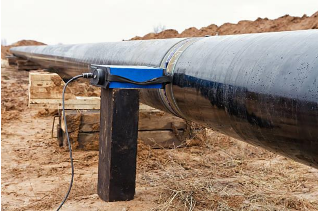
Slika 4.3. Radiografija zavara na plinovodu
