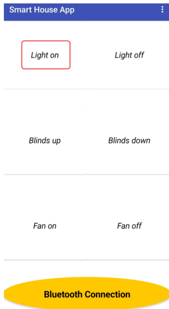
Slika 4.2. Pritisnut je gumb na aplikaciji za paljenje rasvjete, ledica je upaljena.
