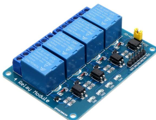
Slika 3.4. Četverokanalni relej modul
