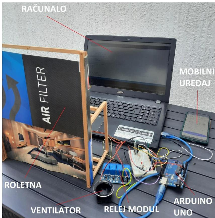
Slika 3.1. Dijelovi pametnog sustava
