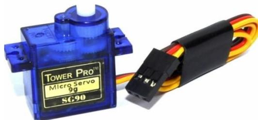
Slika 3.6. TowerPro SG90 servo motor
