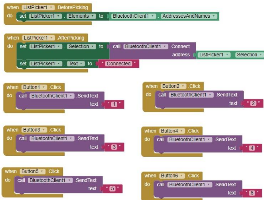
Slika 3.21. Prikaz korištenih blokova naredbi za izradu funkcionalnosti mobilne aplikacije za upravljanje uređajima u smart-home okruženju
