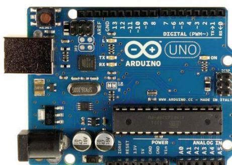
Slika 3.3. Arduino Uno R3 pločica
