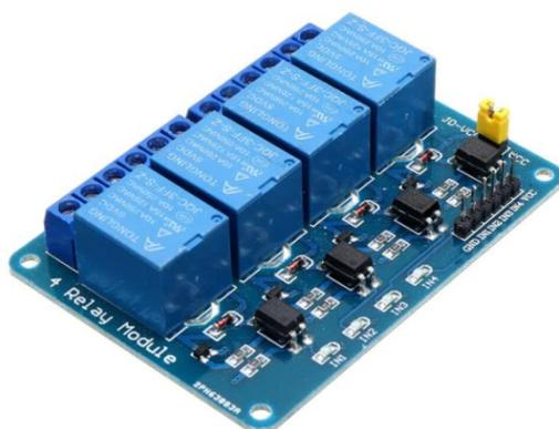
**Slika 3.4.** Četverokanalni relej modul
