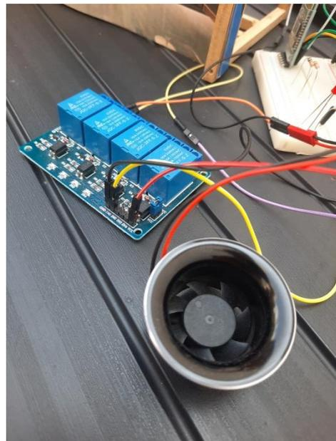
**Slika 4.7.** Pritisnut je gumb na aplikaciji za isključenje ventilatora, ventilator je isključen.
