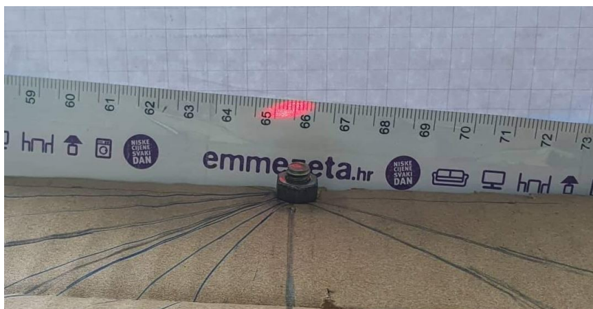
Sl. 4.9 Osvijetljena točka je izdužena prilikom mjerenja pod kutom od 10 stupnjeva
