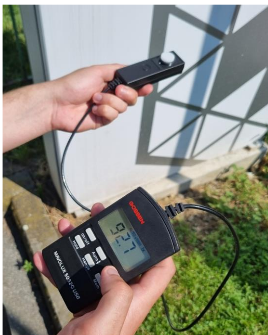
Sl. 4.15. Postupak mjerenja osvijetljenosti, svjetlomjer pokazuje vrijednost osvijetljenosti od 92700 lx.
