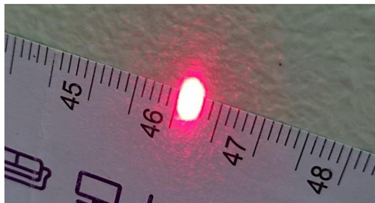
Sl. 4.18. Ovalan oblik točke pri mjerenu sa udaljenosti od 1 m.
