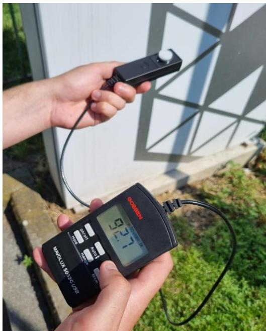
Sl. 4.15. Postupak mjerjenja osvijetljenosti, svjetlomjer pokazuje vrijednost osvijetljenosti od 92700 lx.
