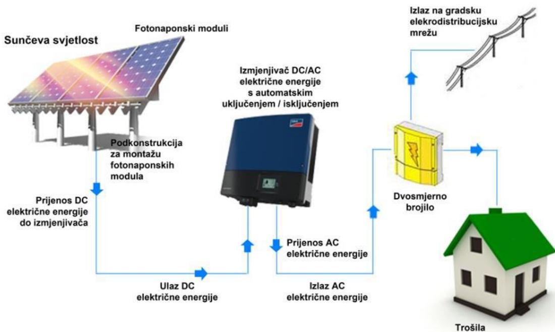
**Slika 2.3.** Pojednostavljeni prikaz mrežnog fotonaponskog sustava [5]
