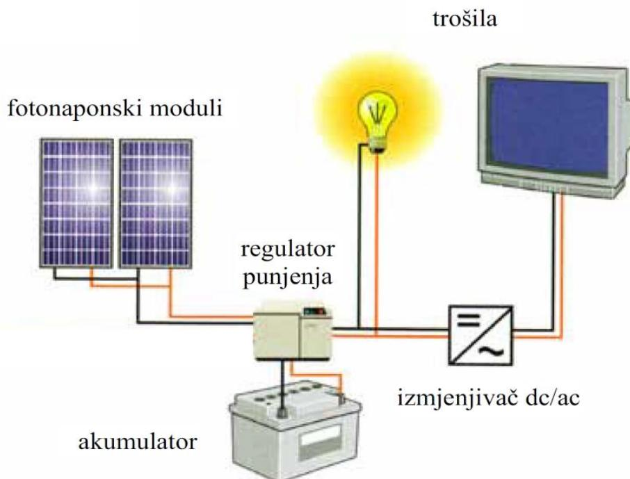
**Slika 2.2.** Pojednostavljeni prikaz samostalnog fotonaponskog sustava [4]
