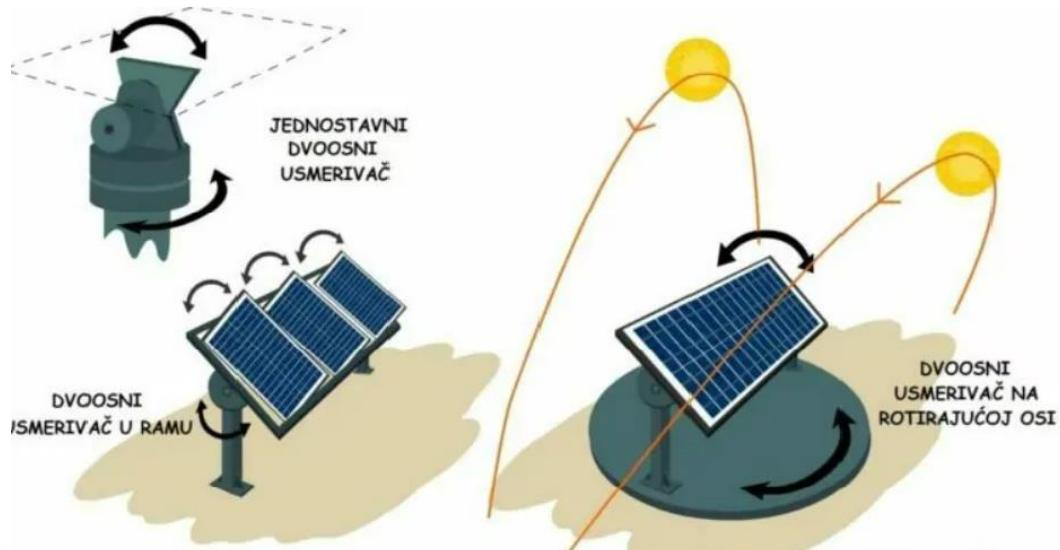
**Slika 3.5.** Pojednostavljeni prikaz sustava s dvoosnim ugađanjem položaja [18]
