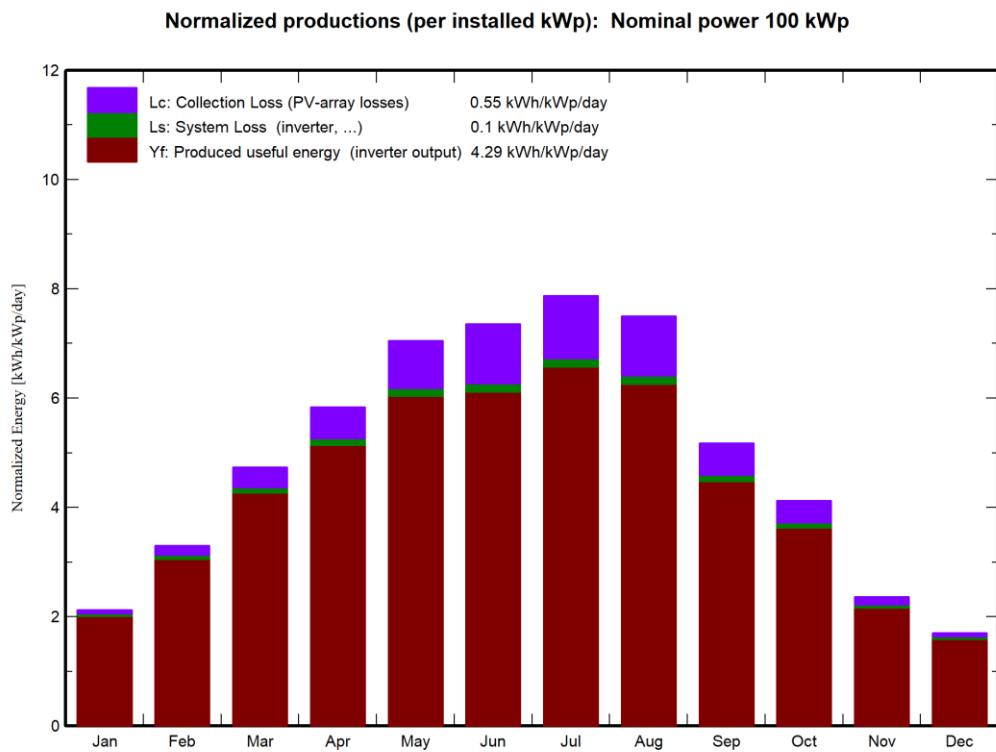
**Slika 4.13.** Proizvodnja električne energije po instaliranom kW snage
