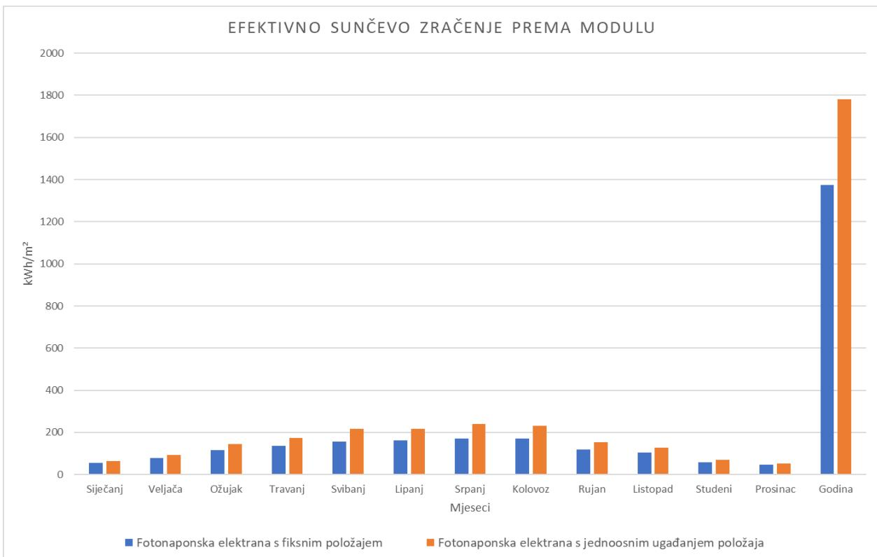
**Slika 4.18.** Grafički prikaz efektivnog Sunčevog zračenja prema modulu
