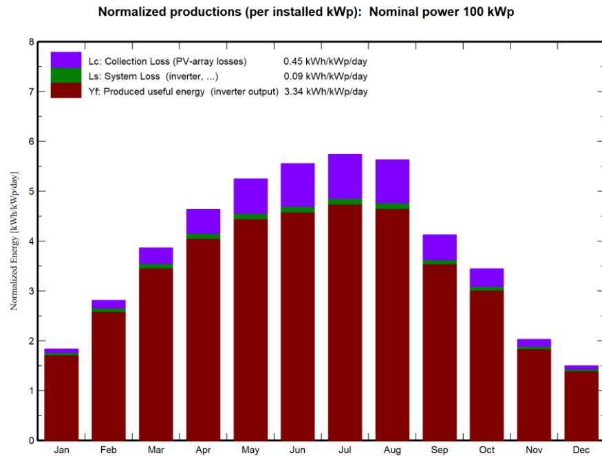
**Slika 4.8.** Proizvodnja električne energije po instaliranom kW snage
