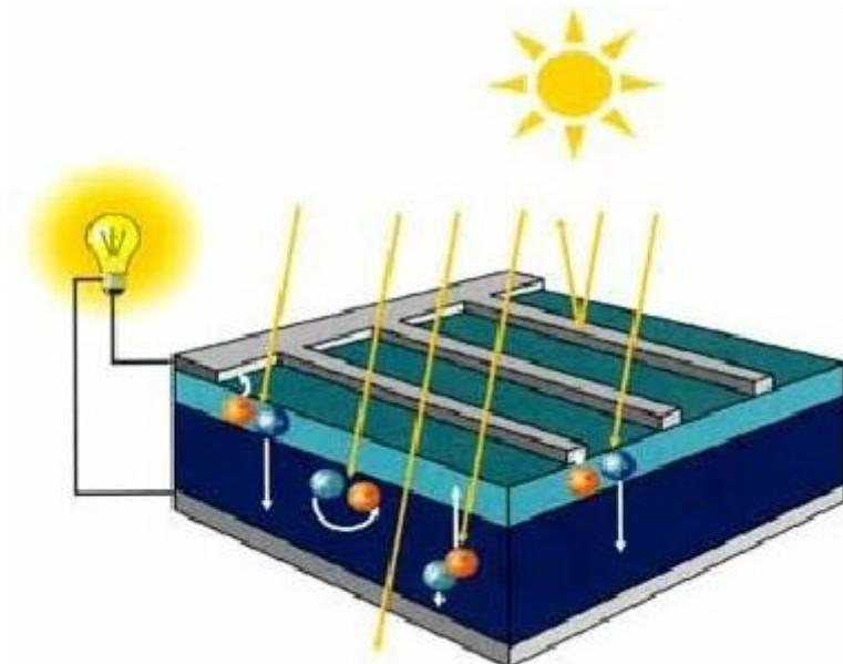
**Slika 2.1.** Pojednostavljeni prikaz djelovanja fotonaponskog efekta [3]
