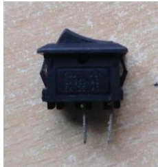
Sl. 3.5. KCD11 JSH prekidač.
