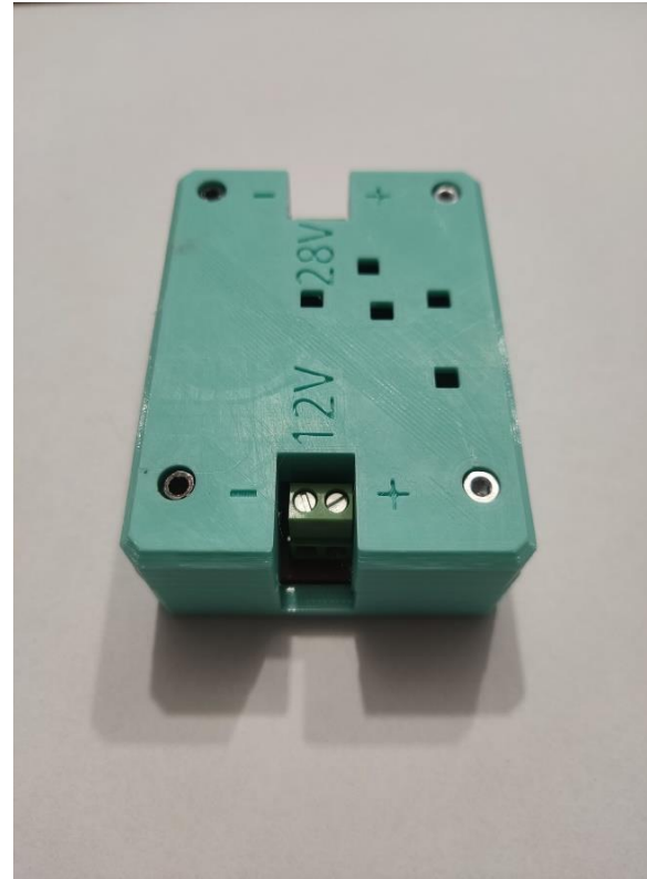
Slika 5.11: a) Maketa pretvarača montirana u bazu kućišta b) Maketa unutar 3D printanog kućišta
