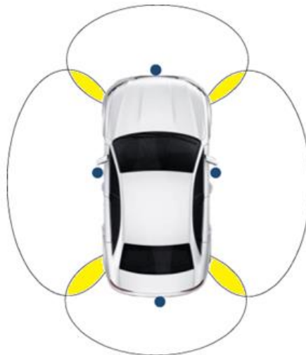
Slika 2.1. Područje prikaza kamera fiksiranih na vozilu [21]
