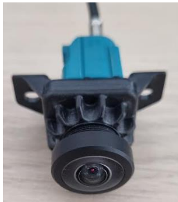
Slika 3.3. Kamera RDACM24B-01 [19] korištena za snimanje okoline
