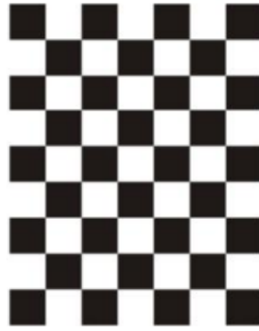
Slika 2.8. Uzorak za kalibraciju kamere korišten u [6]
