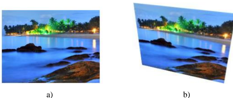
Slika 2.6. Postupak promjene kutova na snimljenoj slici (a) originalna snimljena slika (b) slika nakon promjene kuta pada za 30^\circ i azimutalnog kuta za 25^\circ [20]
