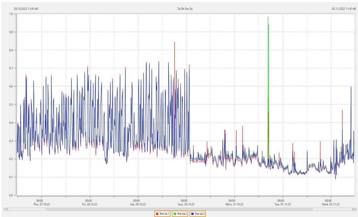
Sl. 3.7. Dijagram kratkotrajnog treperenja napona
