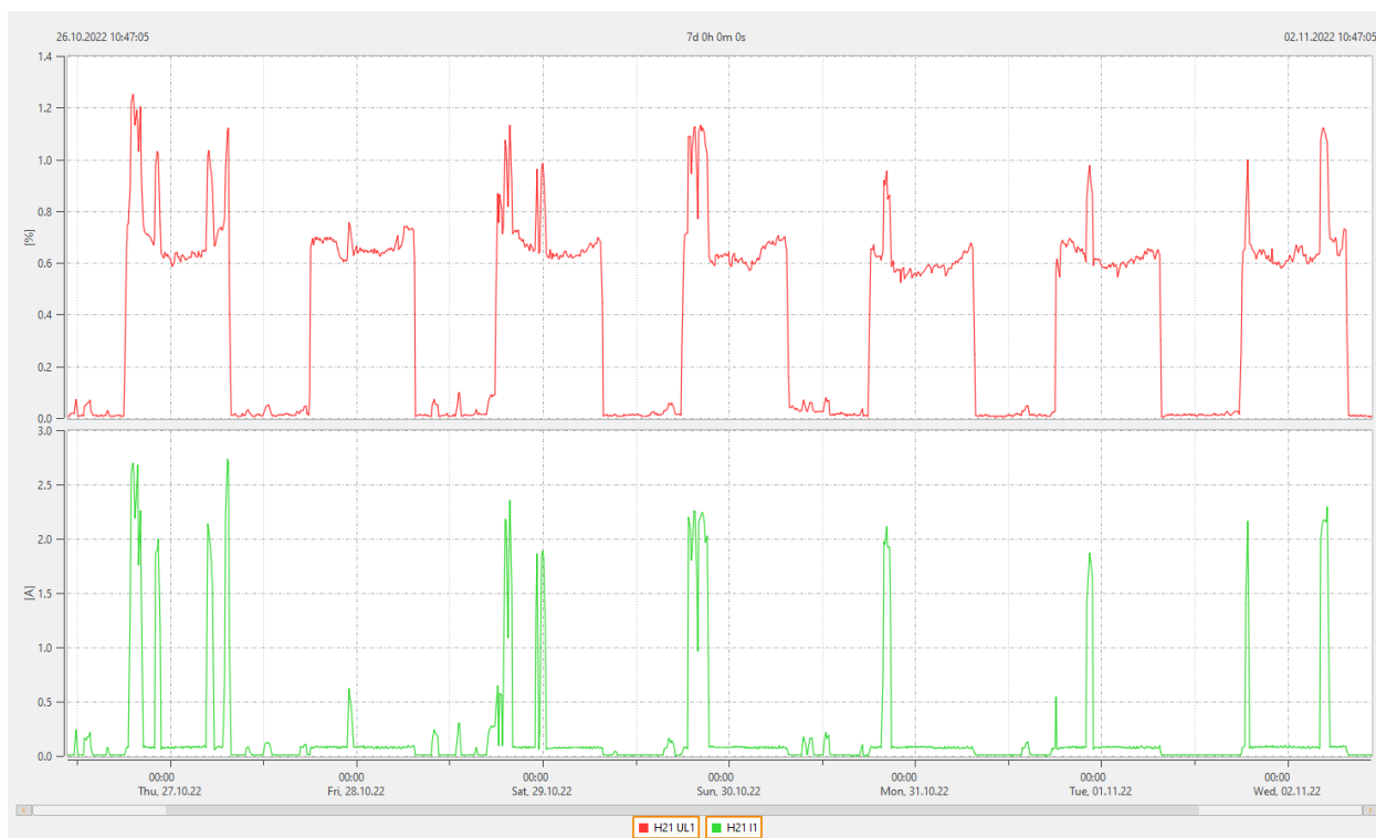
Sl. 4.15. Dijagrami 21. naponskog (gornji dijagram) i strujnog (donji dijagram) harmonika na fazi 1
