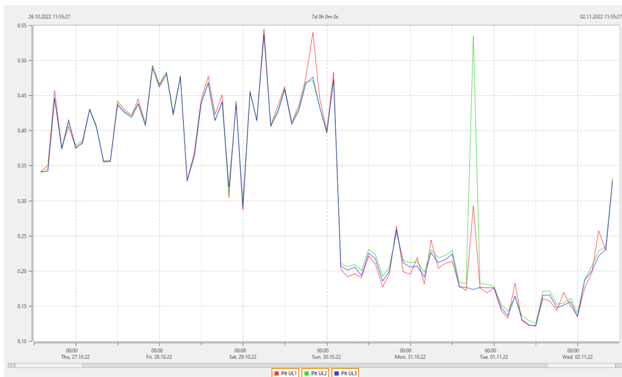
Sl. 4.6. Dijagram treperenja napona 120-minutnih prosječnih vrijednosti
