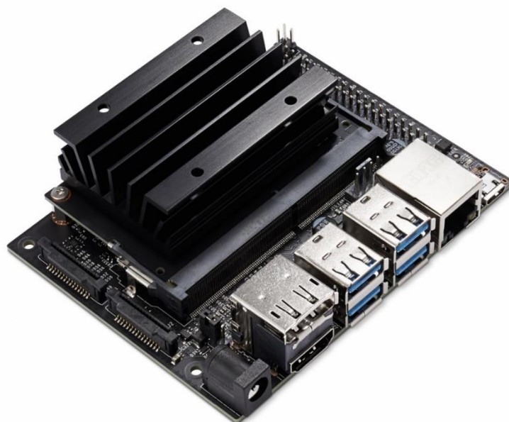
Slika 3.1. Nvidia Jetson Nano [13]
