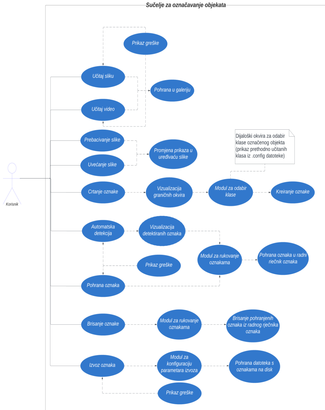
Slika 3.2. Prikaz Use Case dijagrama sučelja za označavanje objekata
