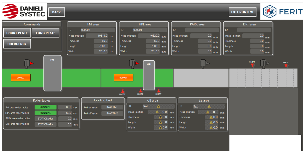
Slika 4.2 Glavni simulacijski zaslon nakon prelaska čelične ploče iz FM područja u HPL područje
