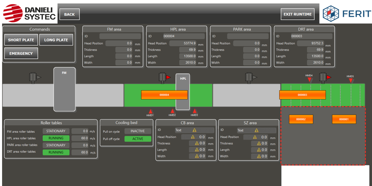
Slika 4.4 Glavni simulacijski zaslon prilikom izvođenja ciklusa pomaka čeličnih ploča na podlozi za hlađenje
