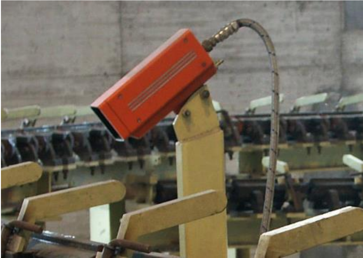
Slika 2.7 Detektor vrućeg metala ID2000 [4]
