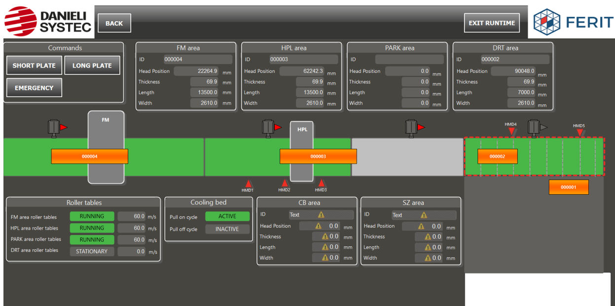
Slika 4.3 Glavni simulacijski zaslon prilikom utovara čelične ploče na podlogu za hlađenje
