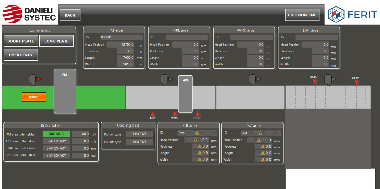
Slika 4.1 Glavni simulacijski zaslon nakon kreiranja čelične ploče u FM području
