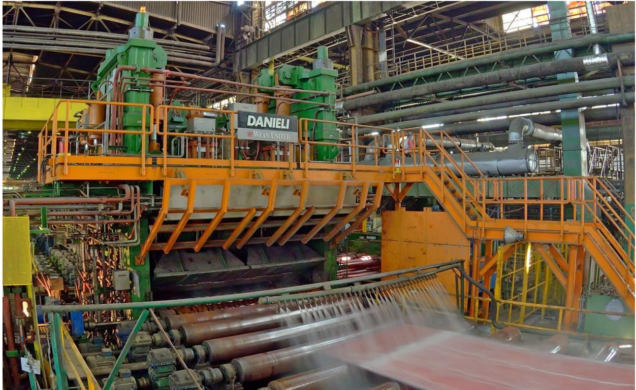
Slika 2.3 Prikaz stroja za površinsko ravnanje [2]
