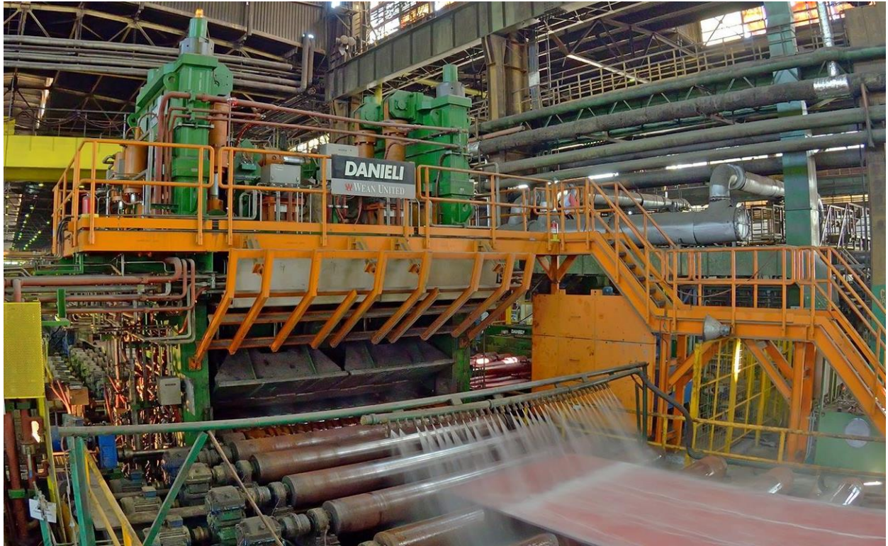
Slika 2.3 Prikaz stroja za površinsko ravnanje [2]
