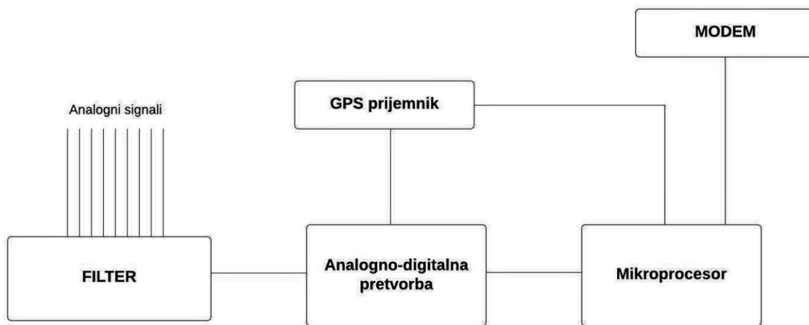
Slika 9. Komponente fazorske mjerne jedinice [3]
