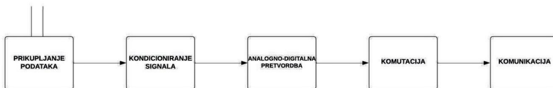
Slika 7. Funkcionalni blok dijagram pametnog brojila [1]
