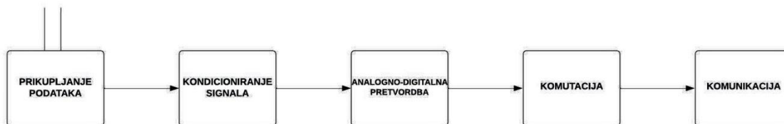
Slika 7. Funkcionalni blok dijagram pametnog brojila [1]
