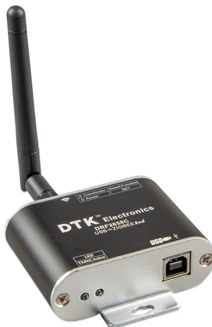
**Slika 18.** Zigbee-to-USB pretvarač [7]
