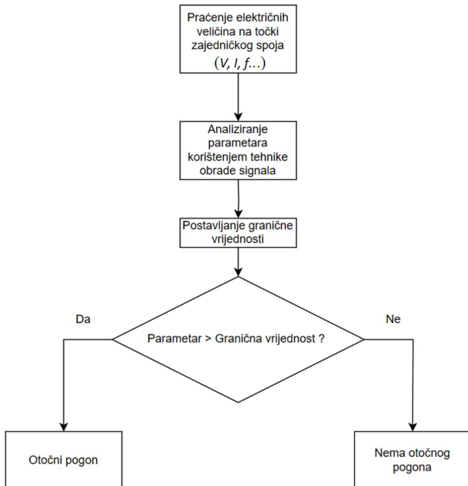
Slika 3.5. Blok dijagram metoda obrade signala [2]
