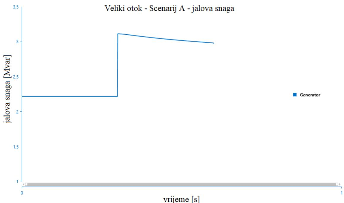
Slika 4.21. Prikaz promjene jalove snage generatora (Veliki otok – Scenarij A)
