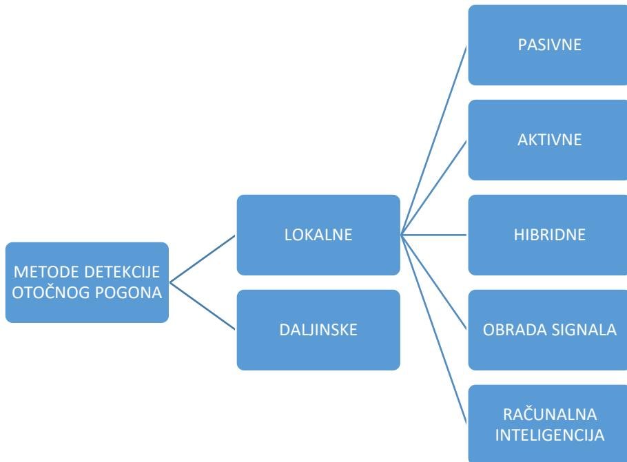
Slika 3.1. Podjela metoda detekcije otočnog pogona [2]
