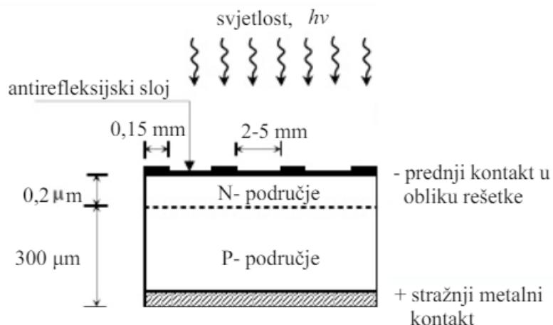
Sl. 2.2. Prikaz silicijeve fotonaponske ćelije, izvor kao [1]
