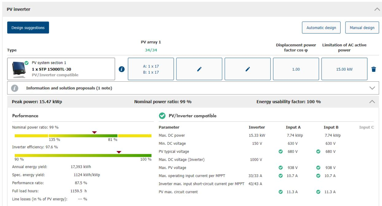
Sl. 3.18. Osnovne karakteristike pretvarača i fotonaponskih nizova.
