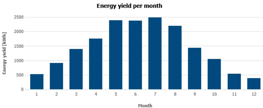
Sl. 3.29. Proizvedena električna energija iz sunčane elektrane.
