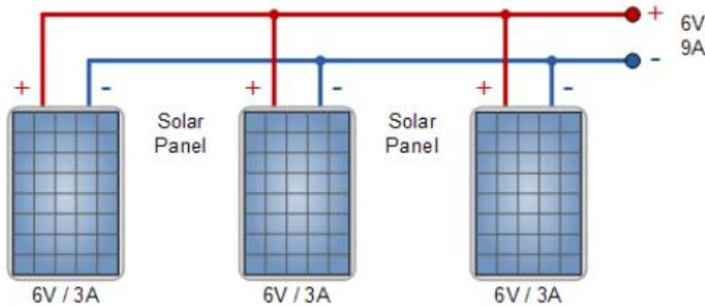
Sl. 2.7. Paralelni spoj fotonaponskih modula, izvor kao [1]
