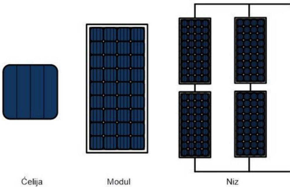
Sl. 2.5. Od fotonaponske ćelije do niza [4].
