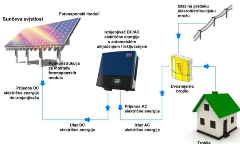
Sl. 2.9. Prikaz mrežnog solarnog sustava [3].
