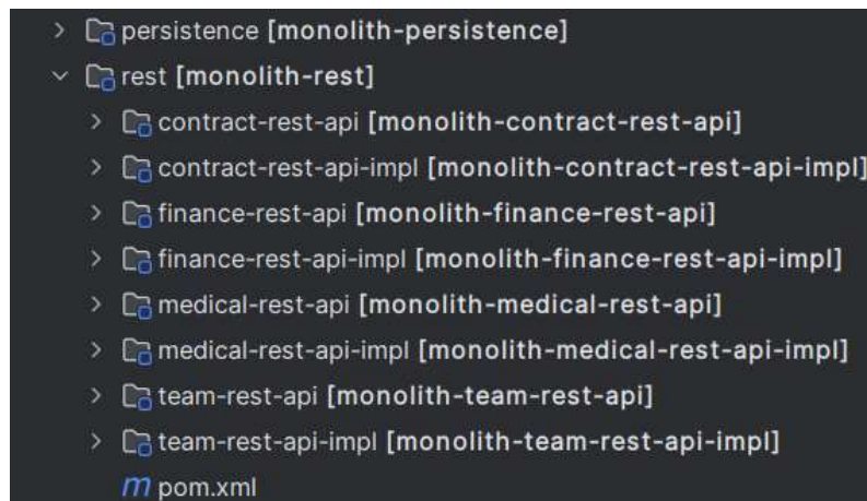
Slika 3.5: Prikaz datotečnog sustava monolitne arhitekture aplikacije
