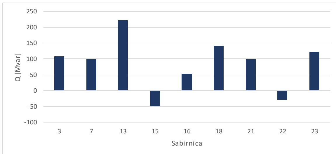
**Slika 6.6.** Jalove snage generatora - scenarij 1, vjetropark snage 398MW
