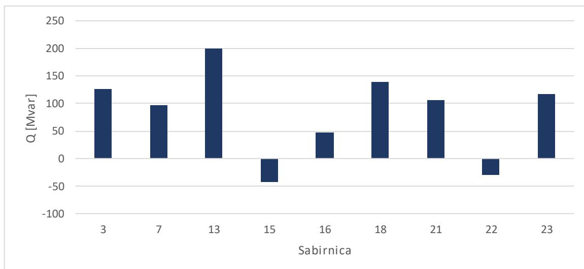
**Slika 6.3.** Jalove snage generatora - scenarij 1, vjetropark snage 200 MW
