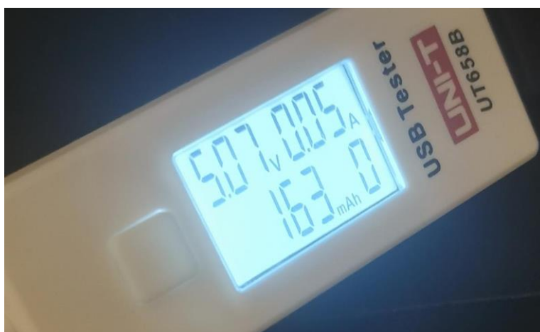
Sl. 5.4. Vrijednost struje za vrijeme slanja HTTP zahtjeva
