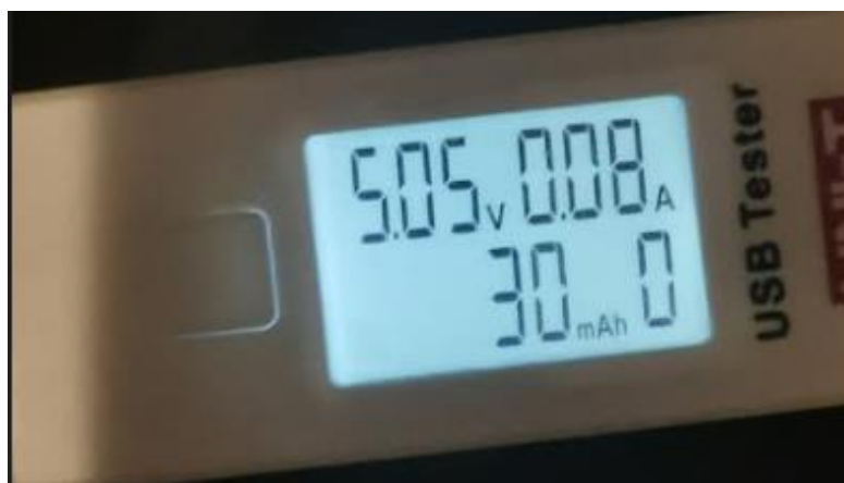
Sl. 5.3. Vrijednost struje nakon odaslane TCP poruke
