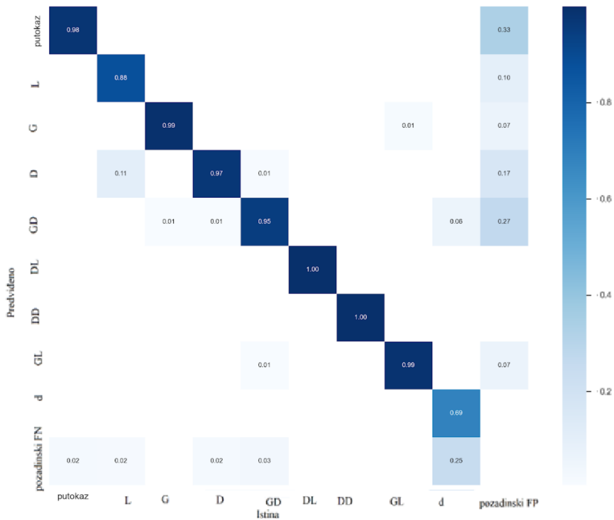
Slika 3.19. Matrica zabune za yolov7-tiny.pt model s 9 klasa na validacijskom skupu podataka
